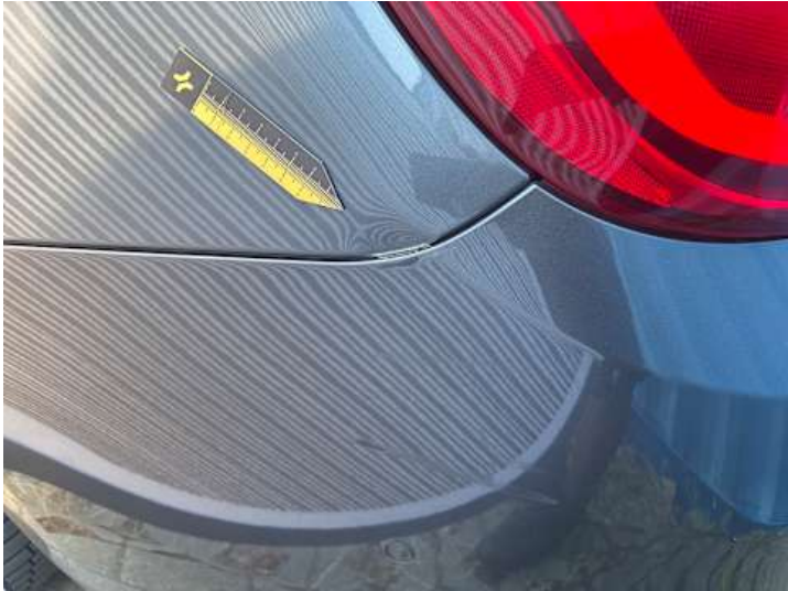
Seitenteil hinten links (Delle, Verformung, Kratzer)
