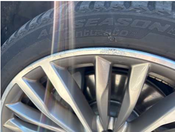
Rad (Kratzer, Kerben, Rost)
