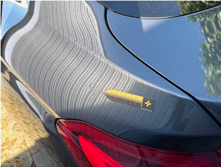
Seitenteil hinten links (Delle, Verformung, Kratzer)
