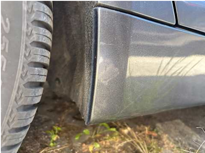
Schweller rechts (Kratzer)
