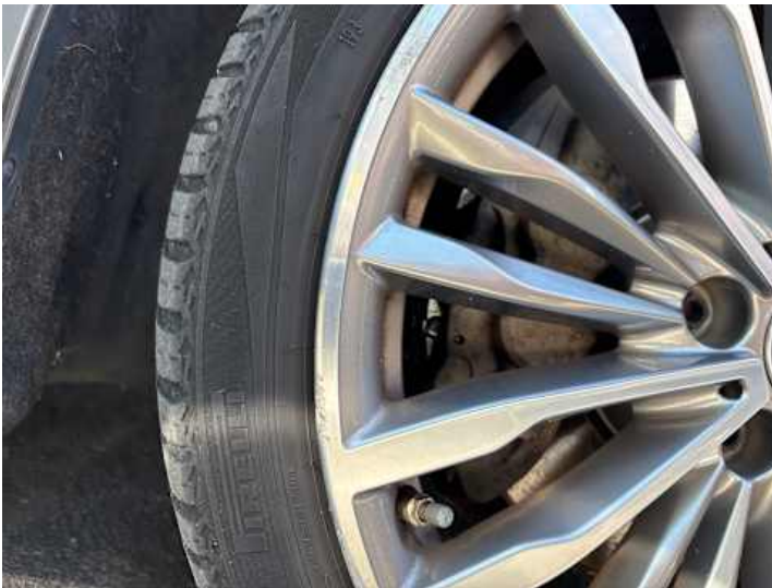
Rad (Kratzer, Kerben, Rost)
