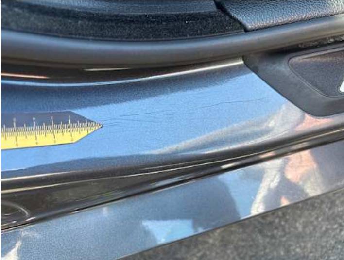
Schweller rechts (Kratzer)
