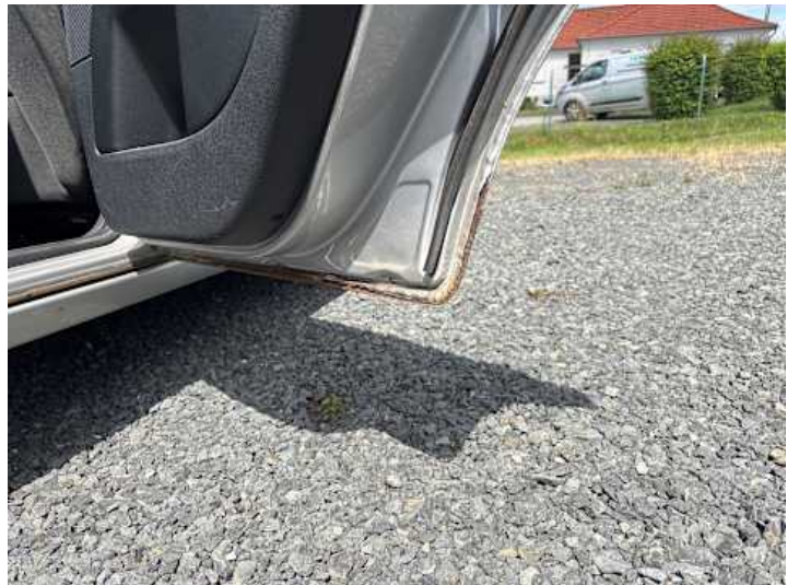
Türe hinten rechts (Rost)
