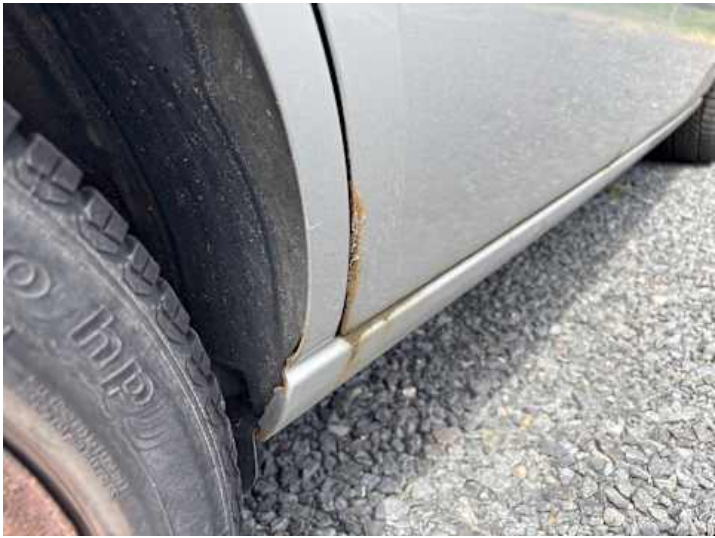
Seitenteil hinten rechts (Rost)
