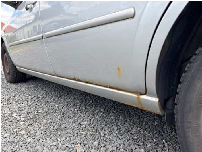
Türe hinten links (Rost)
