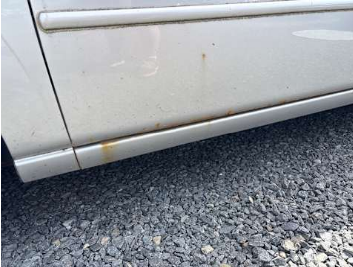
Schweller links (Rost)
