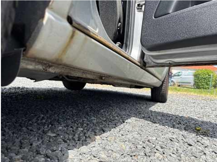
Schweller rechts (Rost)
