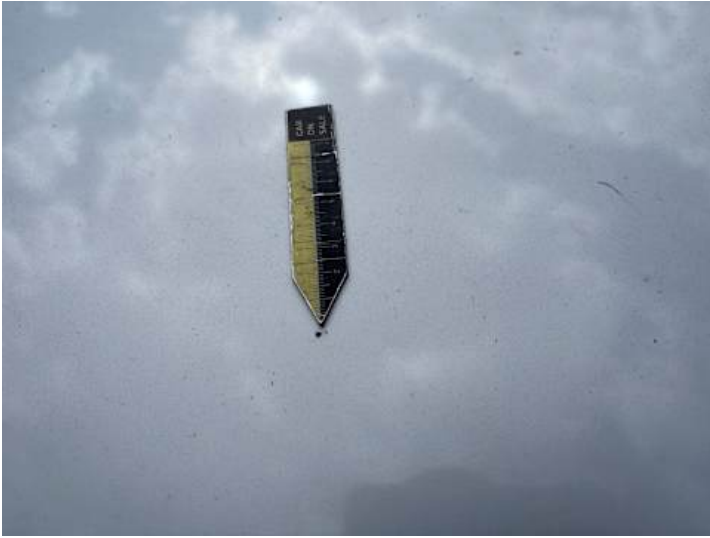
Motorhaube (Steinschlag, Rost)
