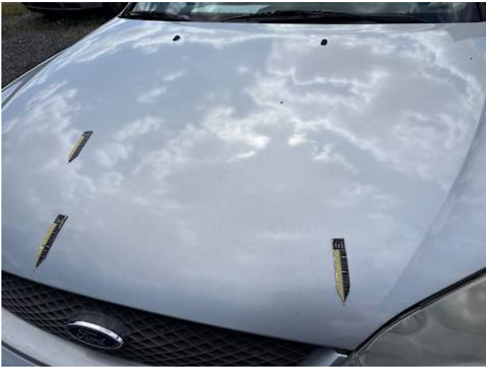
Motorhaube (Steinschlag, Rost)
