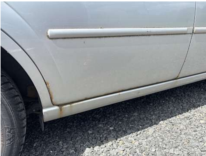
Türe hinten rechts (Rost)
