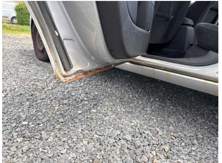
Türe hinten links (Rost)
