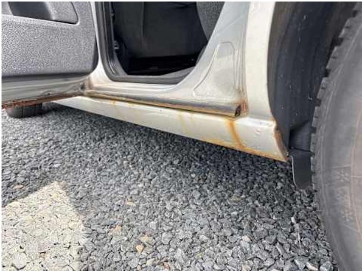
Schweller links (Rost)
