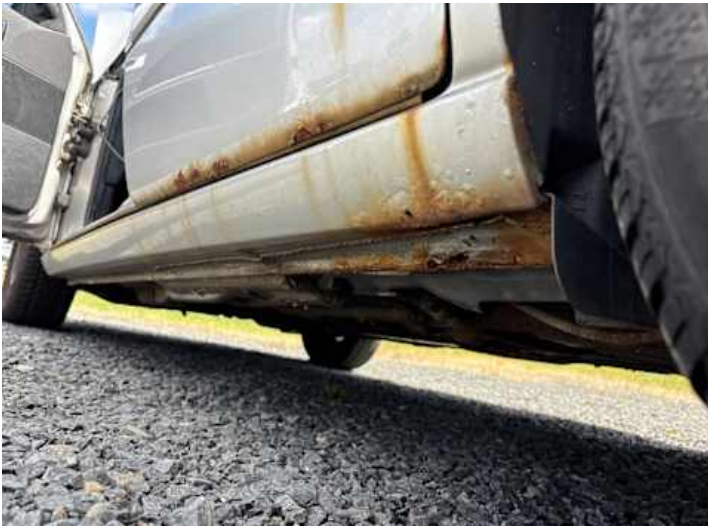
Schweller links (Rost)
