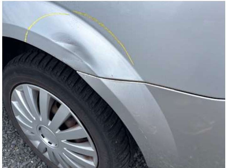
Stoßstange hinten (Verformung, Kratzer)
