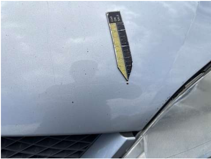
Motorhaube (Steinschlag, Rost)
