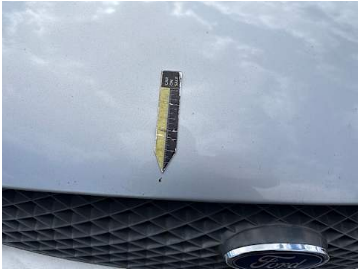
Motorhaube (Steinschlag, Rost)
