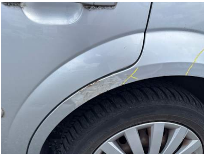
Seitenteil hinten links (Kratzer, Lackschaden, Rost, Verformung, Unsachgemäß instand gesetzt)
