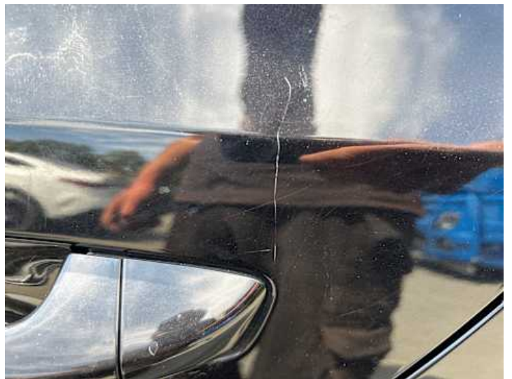
Türe hinten links (Lackschaden, Kratzer)
