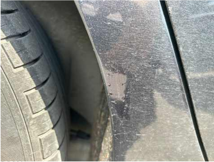
Seitenteil hinten rechts (Lackschaden, Rost)
