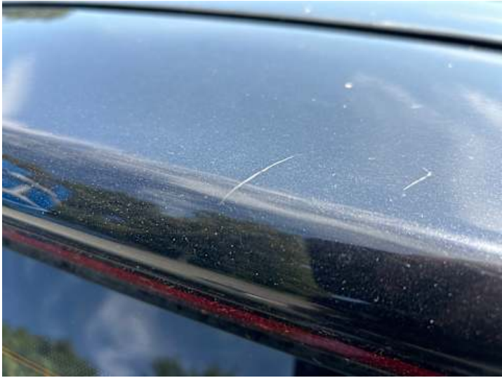
Heckklappe (Kratzer, Lackschaden)
