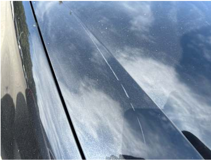
Motorhaube (Lackschaden, Kratzer)
