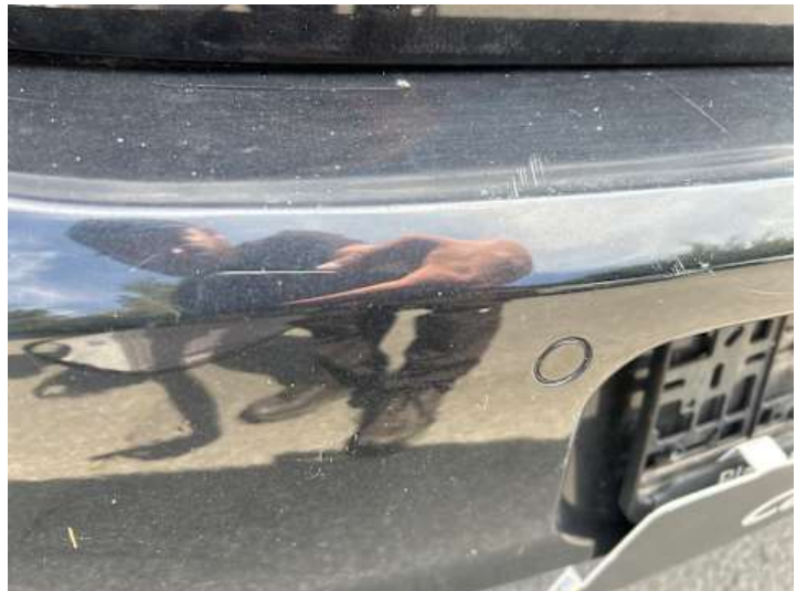
Stoßstange hinten (Lackschaden)
