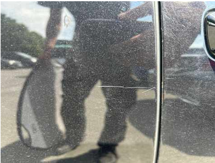
Türe hinten rechts (Kratzer, Lackschaden)
