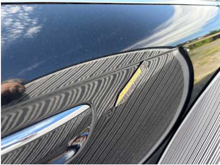
Türe hinten rechts (Delle)
