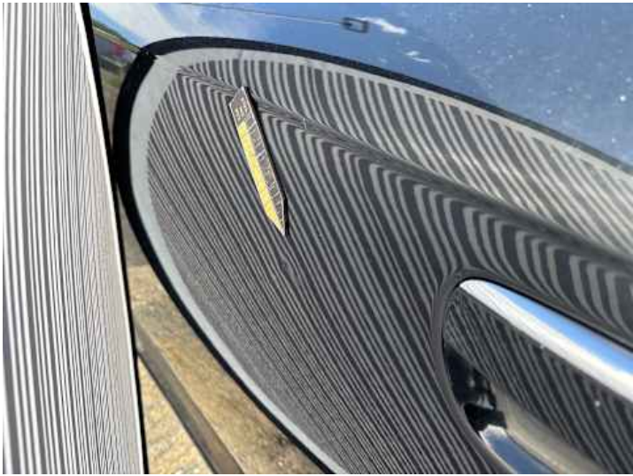
Türe hinten links (Delle, Kratzer)
