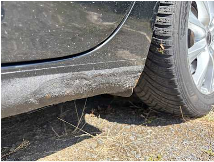
Schweller links (Rost)
