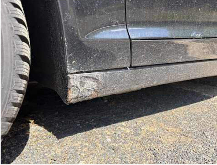
Schweller links (Rost)
