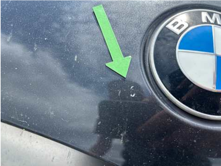
Motorhaube (Lackschaden, Steinschlag)
