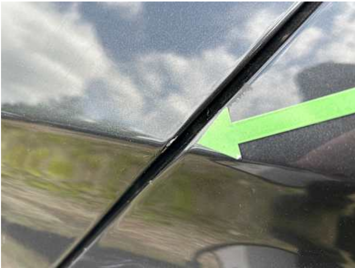
Türe hinten links (Lackschaden)
