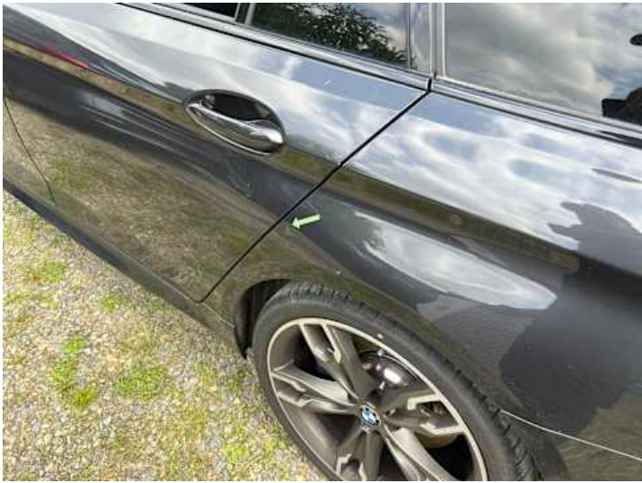
Seitenteil hinten links (Delle)
