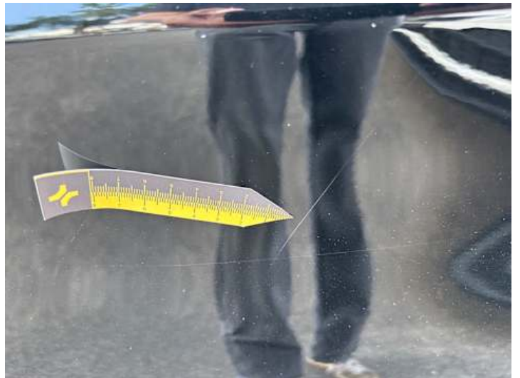
Türe hinten links (Kratzer)
