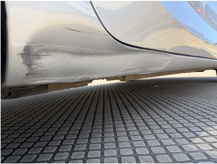
Schweller rechts (Verformung, Lackschaden)
