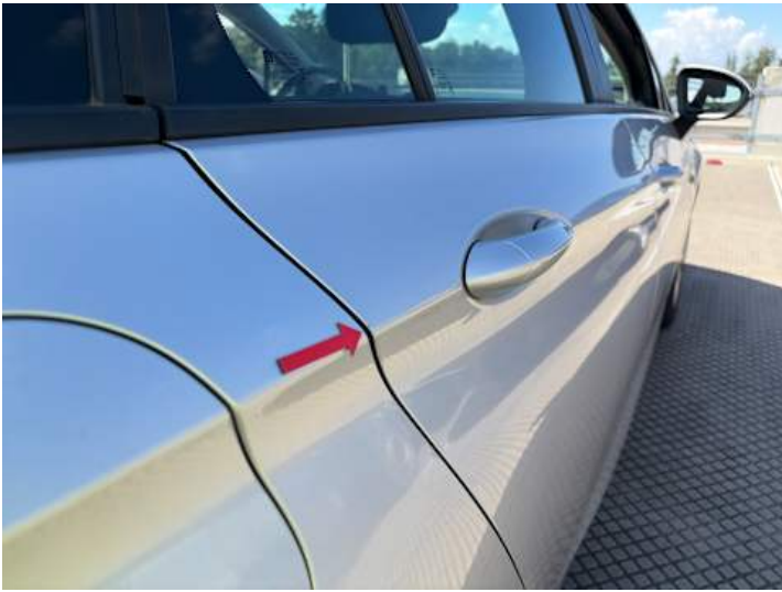
Türe hinten rechts (Lackschaden)
