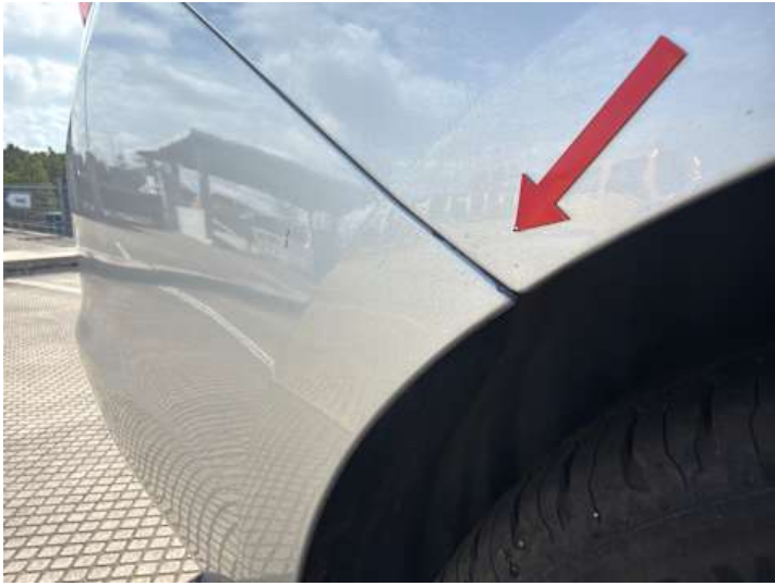
Stoßstange hinten (Lackschaden)
