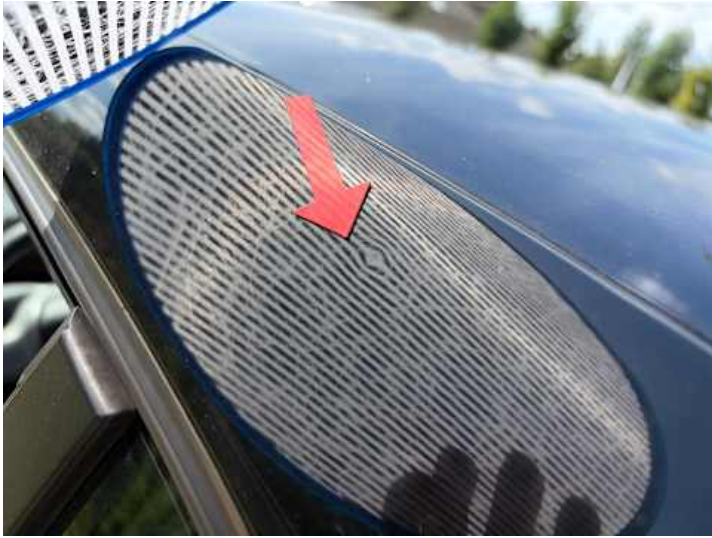
Dach (Lackschaden, Delle)
