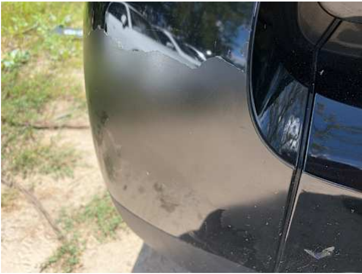
Stoßstange hinten (Lackschaden, Ausgeblichen/Matt, Riss/Bruch)
