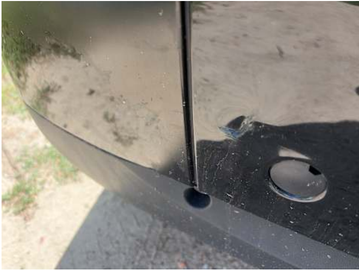
Stoßstange hinten (Lackschaden, Ausgeblichen/Matt, Riss/Bruch)
