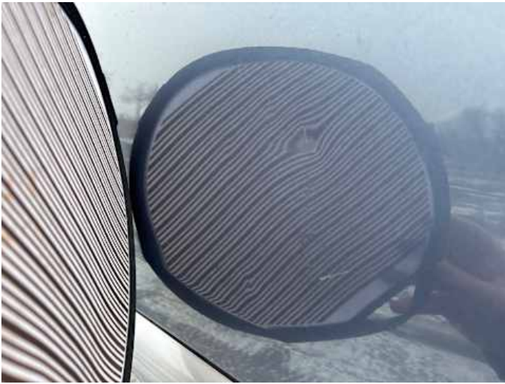
Türe hinten rechts (Delle, Verformung, Lackschaden)
