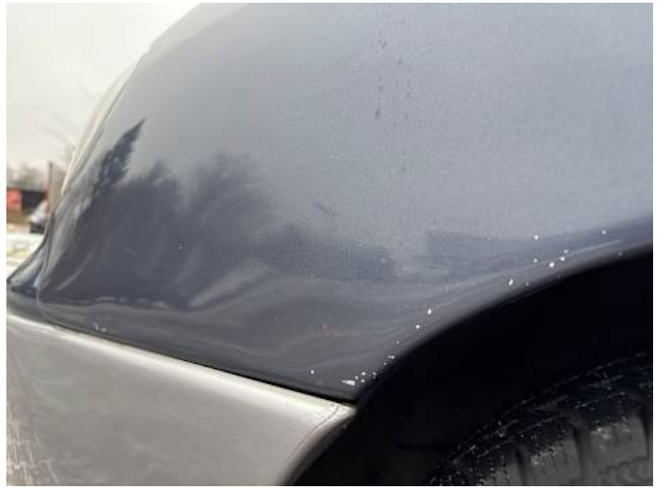
Kotflügel vorne links (Delle, Lackschaden, Verformung, Rost)
