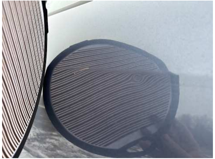
Türe hinten rechts (Delle, Verformung, Lackschaden)
