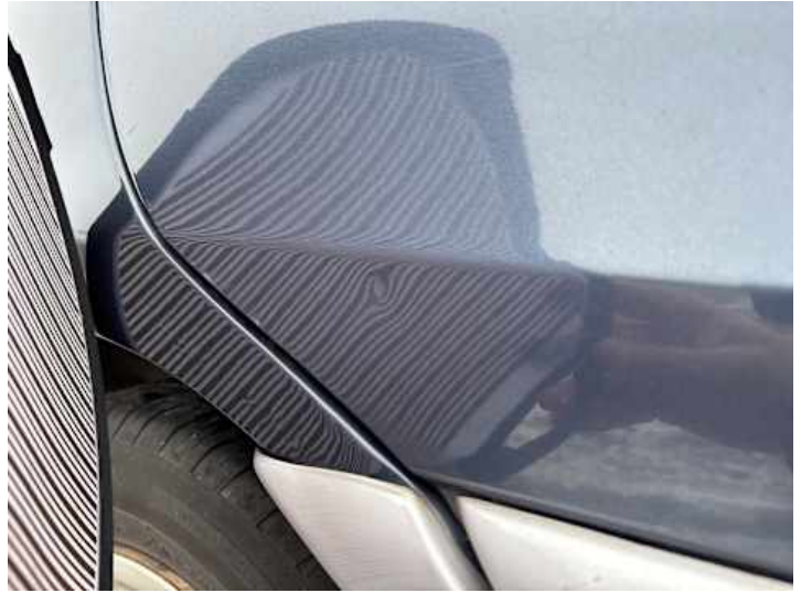
Türe hinten rechts (Delle, Verformung, Lackschaden)
