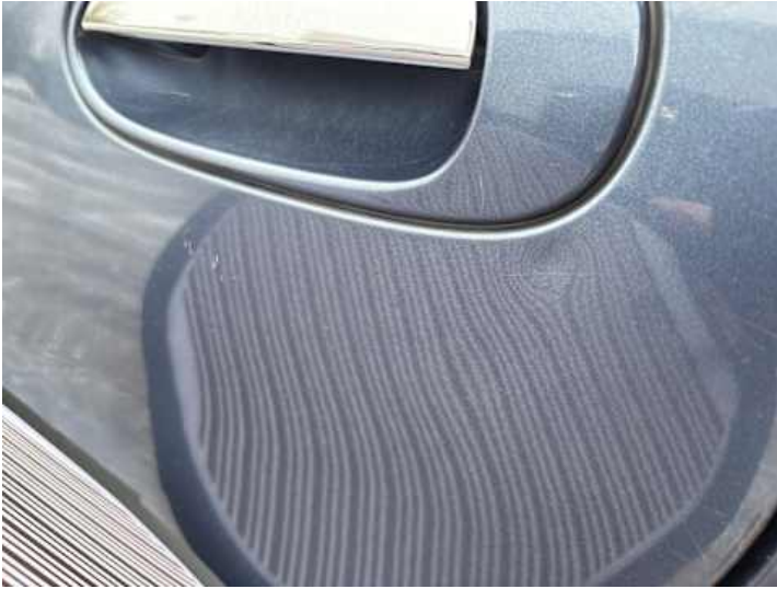
Türe hinten links (Delle, Verformung)
