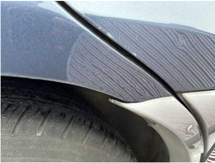
Seitenteil hinten rechts (Unsachgemäß instand gesetzt)
