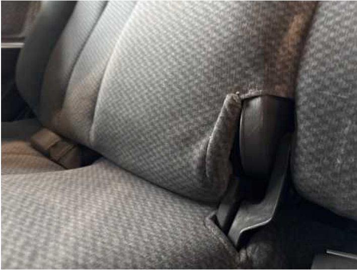
Innenraum (Kratzer, Verschmutzung, Verschleiß)
