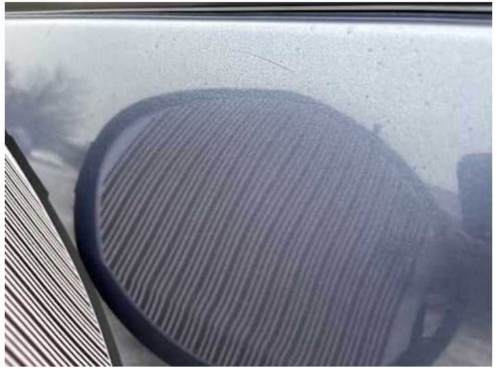
Türe hinten links (Delle, Verformung)
