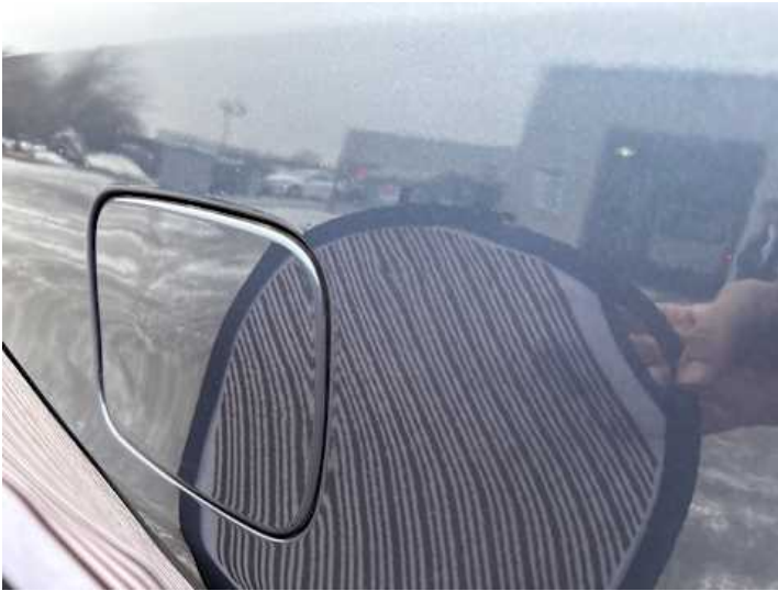
Seitenteil hinten links (Delle, Verformung, Unsachgemäß instand gesetzt)
