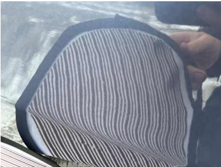
Seitenteil hinten rechts (Unsachgemäß instand gesetzt)
