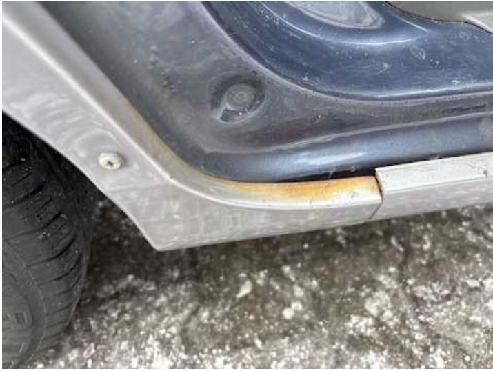
Schweller rechts (Rost, Lackschaden)
