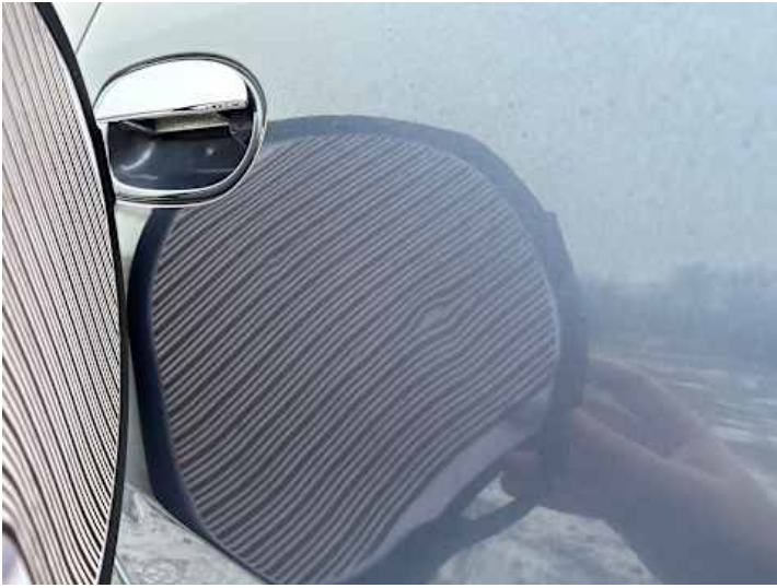
Türe hinten rechts (Delle, Verformung, Lackschaden)
