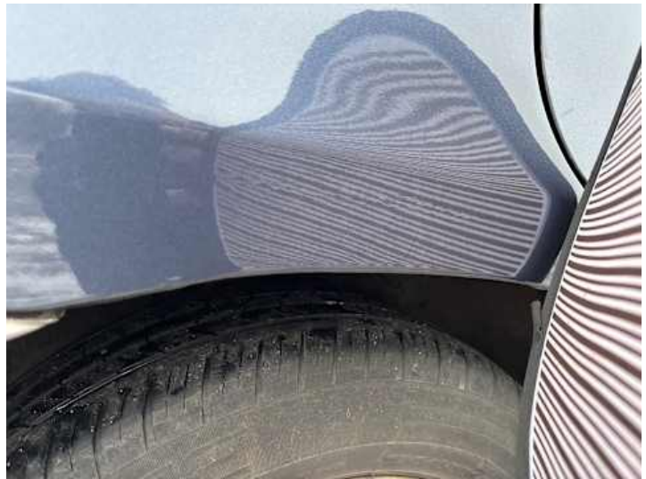
Seitenteil hinten rechts (Unsachgemäß instand gesetzt)
