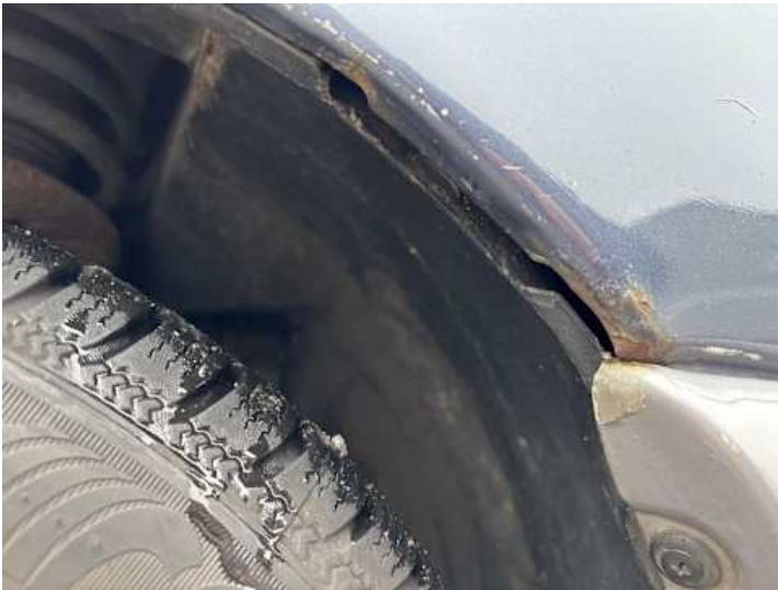
Kotflügel vorne links (Delle, Lackschaden, Verformung, Rost)
