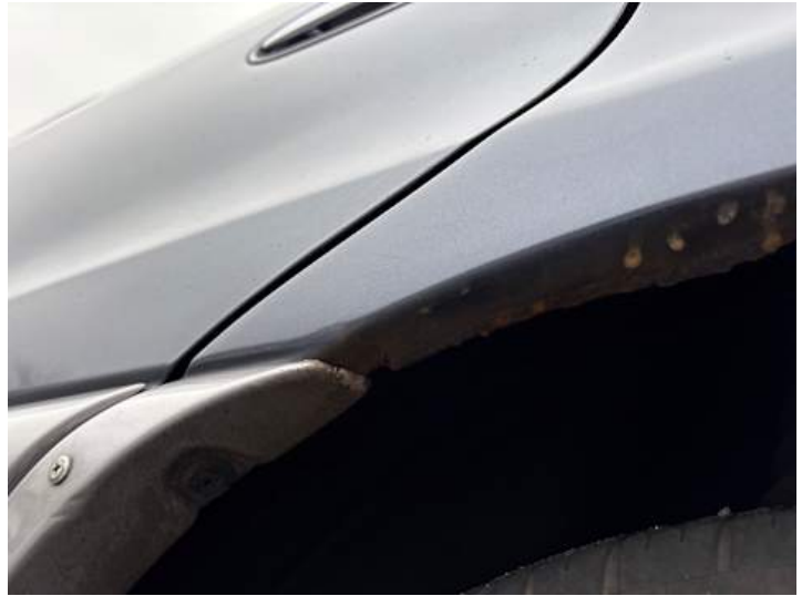
Seitenteil hinten links (Rost, Lackschaden)
