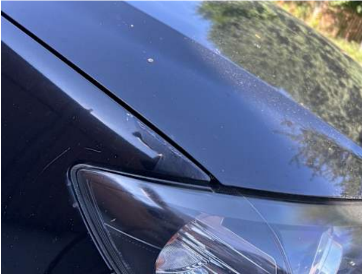
Kotflügel vorne rechts (Lackschaden, Unsachgemäß instand gesetzt, Rost)
