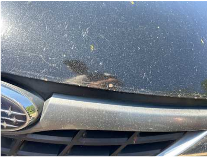
Motorhaube (Steinschlag, Rost)
