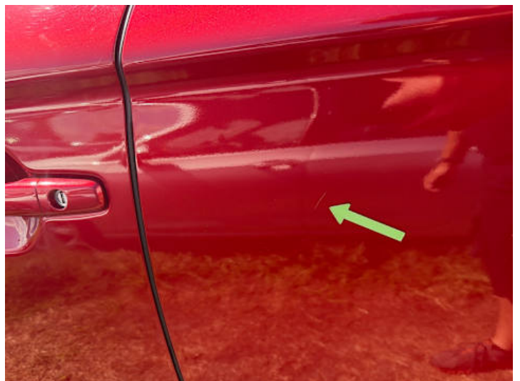
Türe hinten links (Kratzer)
