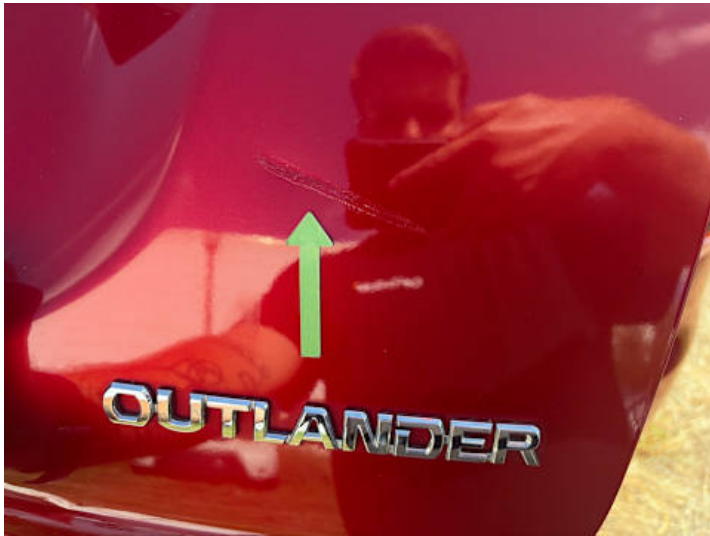
Heckklappe (Kratzer, Unsachgemäß instand gesetzt)
