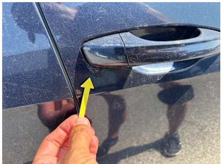
Beifahrertür (Delle, Rost)
