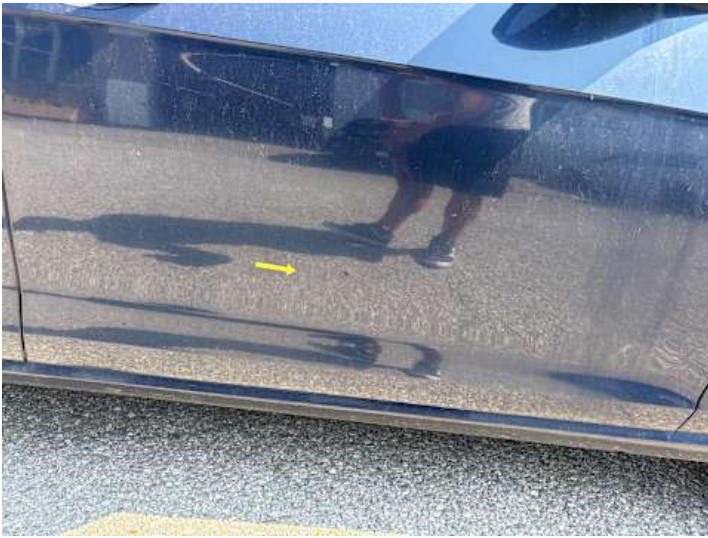
Beifahrertür (Delle, Rost)
