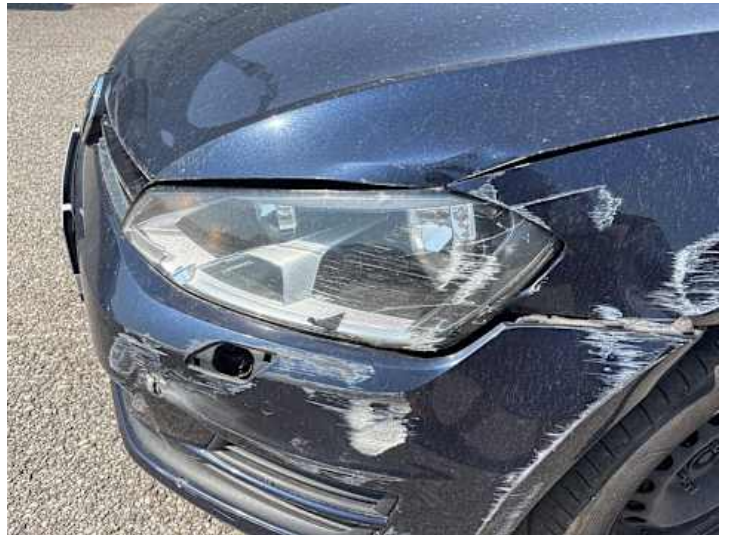
Scheinwerfer (links) (Riss/Bruch)
