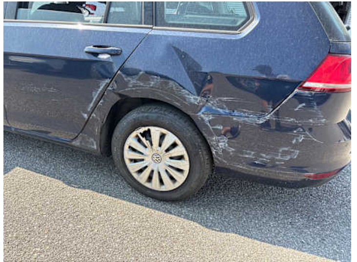
Seitenteil hinten links (Verformung)
