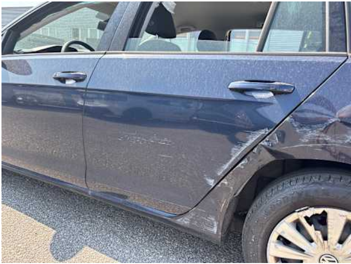
Türe hinten links (Verformung)
