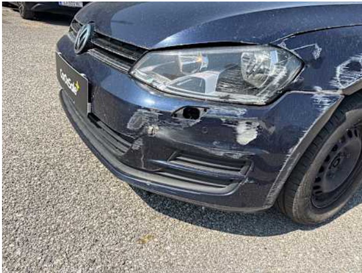
Stoßstange vorne (Riss/Bruch)
