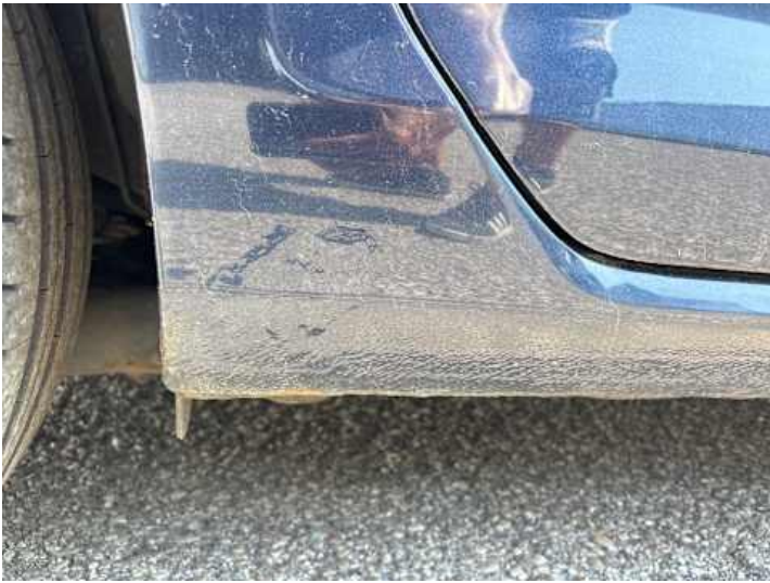
Schweller rechts (Rost)
