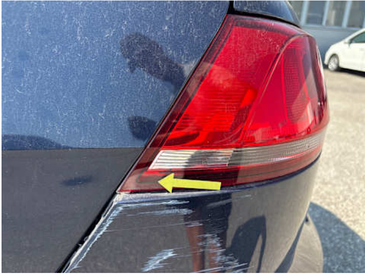
Rücklicht (links) (Riss/Bruch)
