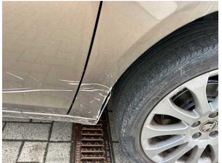
Kotflügel vorne rechts (Delle, Kratzer)
