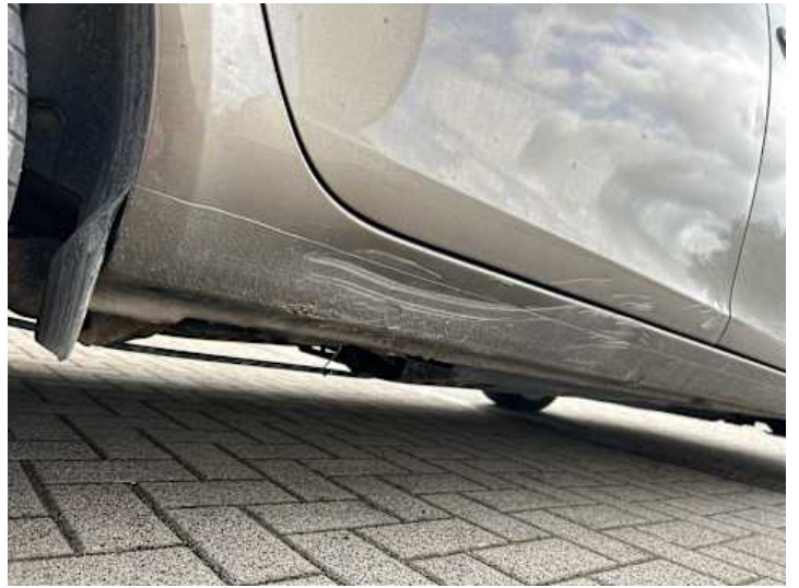
Schweller rechts (Verformung, Kratzer)
