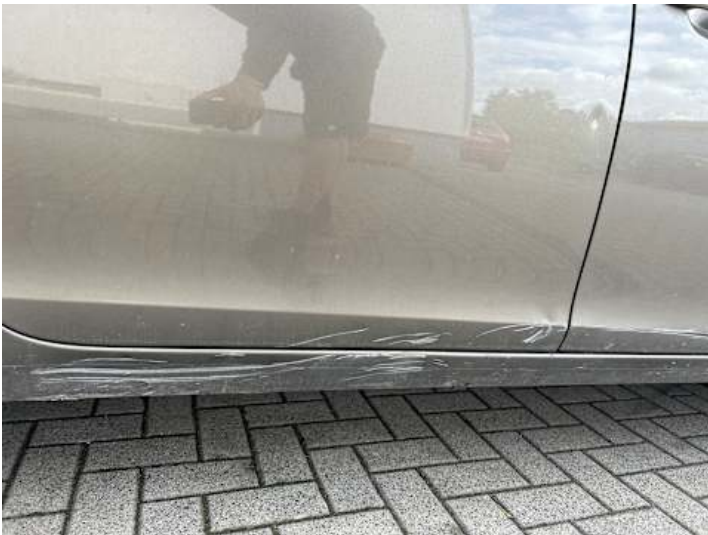
Türe hinten rechts (Delle, Kratzer)
