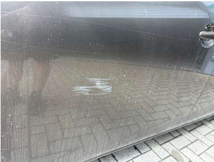
Fahrtür (Delle, Kratzer)
