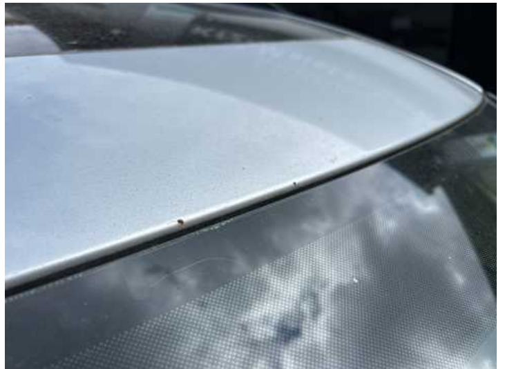
Dach (Rost, Steinschlag)
