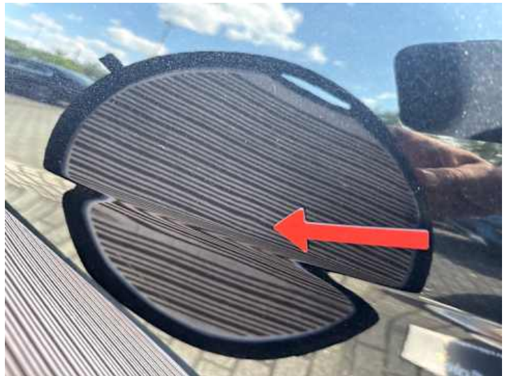
Türe hinten links (Delle)
