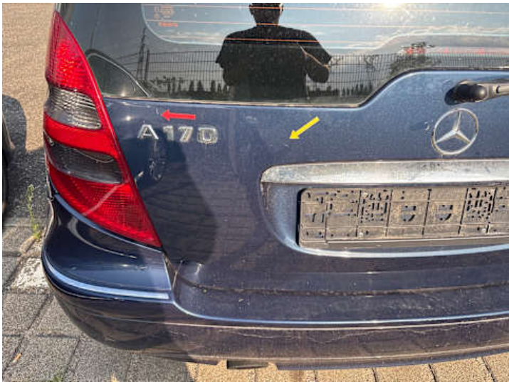
Heckklappe (Spaltmaße ungenau)
