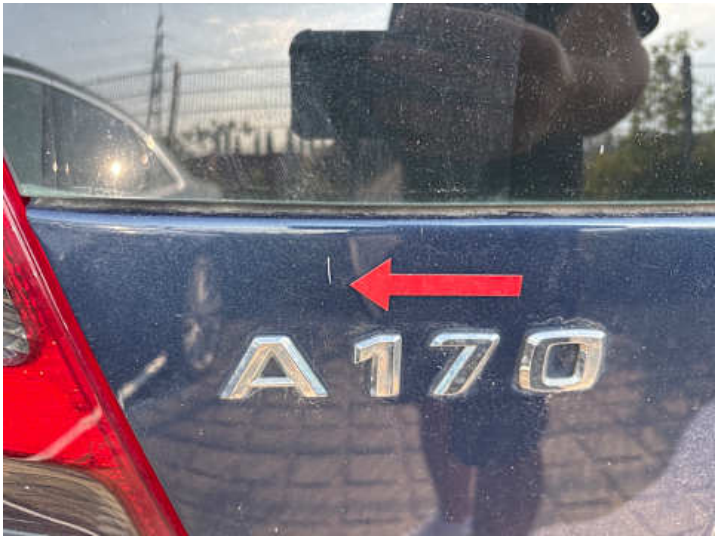
Heckklappe (Spaltmaße ungenau)
