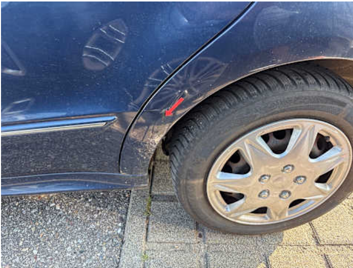
Seitenteil hinten links (Rost)
