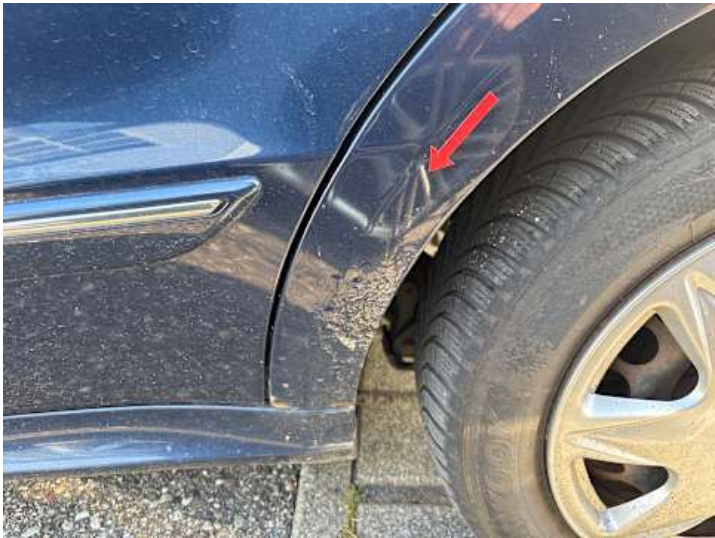
Seitenteil hinten links (Rost)
