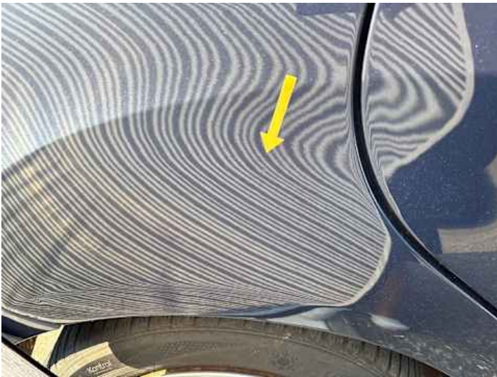
Seitenteil hinten rechts (Unsachgemäß instand gesetzt)
