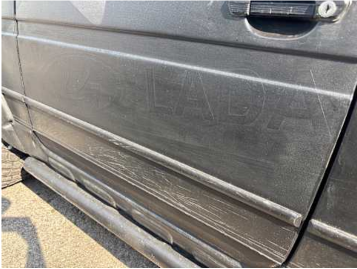
Fahrtür (Lackschaden, Unsachgemäß instand gesetzt)
