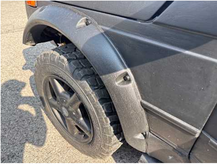
Kotflügel vorne links (Lackschaden, Unsachgemäß instand gesetzt)
