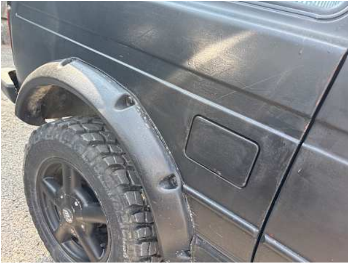
Seitenteil hinten rechts (Lackschaden, Unsachgemäß instand gesetzt)
