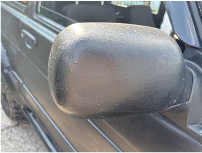
Beifahrertür (Lackschaden, Unsachgemäß instand gesetzt)
