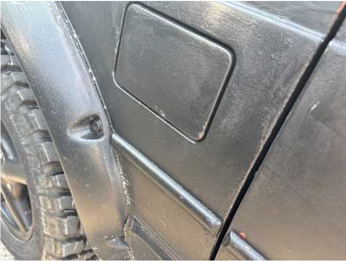
Seitenteil hinten rechts (Lackschaden, Unsachgemäß instand gesetzt)
