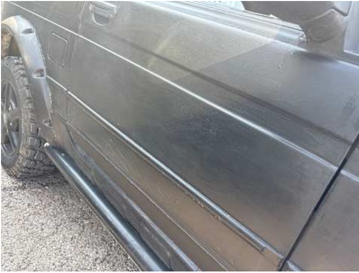
Beifahrtür (Lackschaden, Unsachgemäß instand gesetzt)
