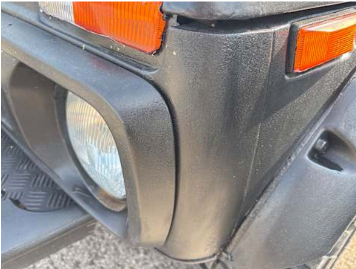
Stoßstange vorne (Lackschaden, Unsachgemäß instand gesetzt)
