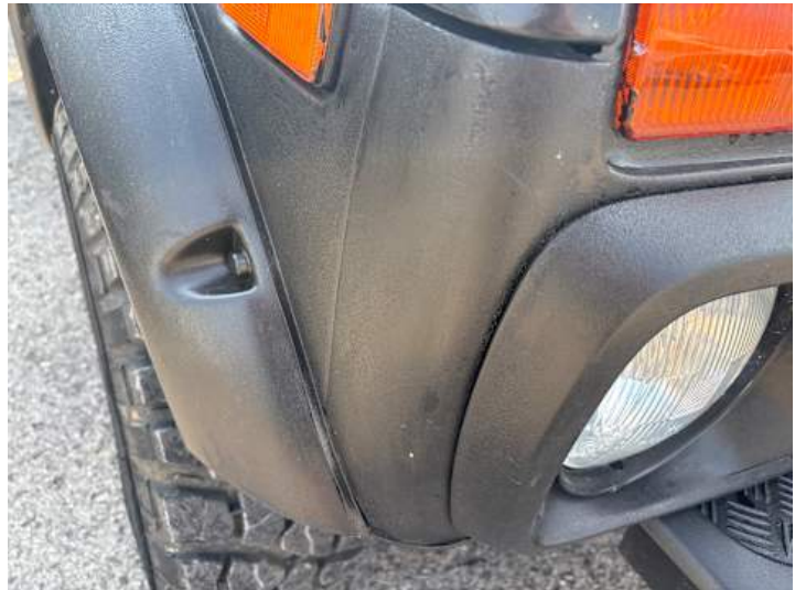
Stoßstange vorne (Lackschaden, Unsachgemäß instand gesetzt)
