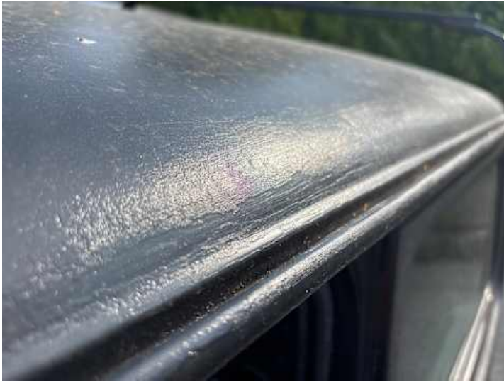
Dach (Lackschaden, Unsachgemäß instand gesetzt)
