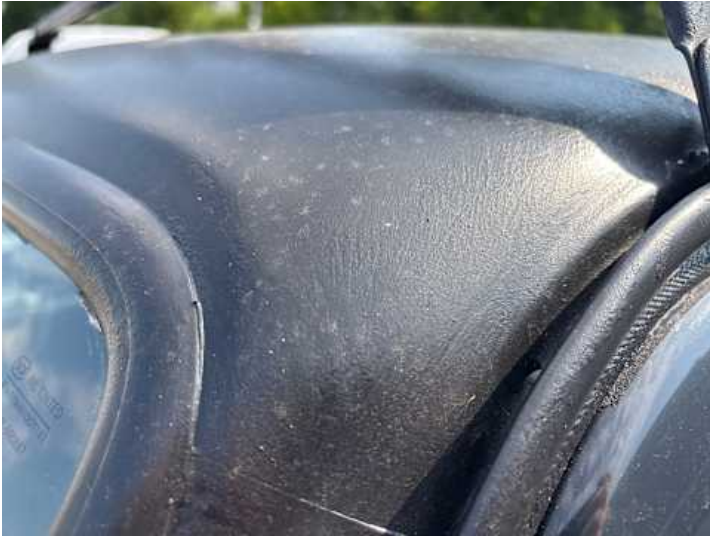
Dach (Lackschaden, Unsachgemäß instand gesetzt)
