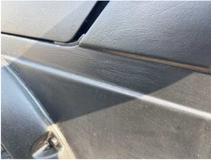
Kotflügel vorne links (Lackschaden, Unsachgemäß instand gesetzt)
