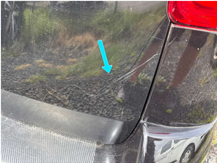
Heckklappe (Kratzer, Delle)
