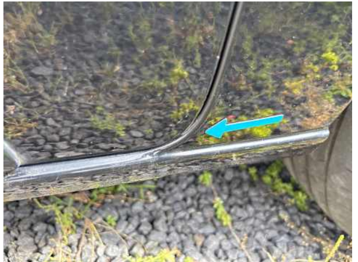
Seitenteil hinten links (Lackschaden)
