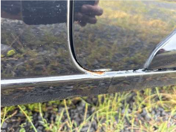
Türe hinten rechts (Rost)
