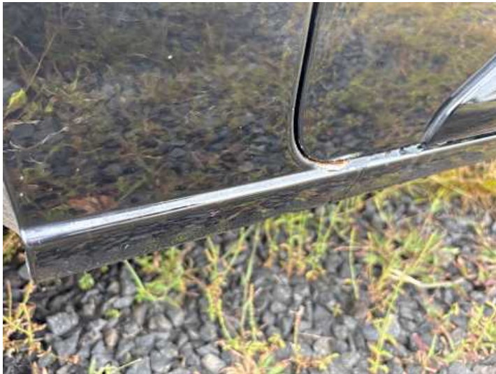
Schweller rechts (Rost)
