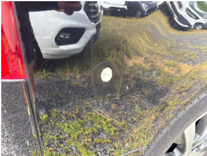
Seitenteil hinten rechts (Delle, Unsachgemäß instand gesetzt)
