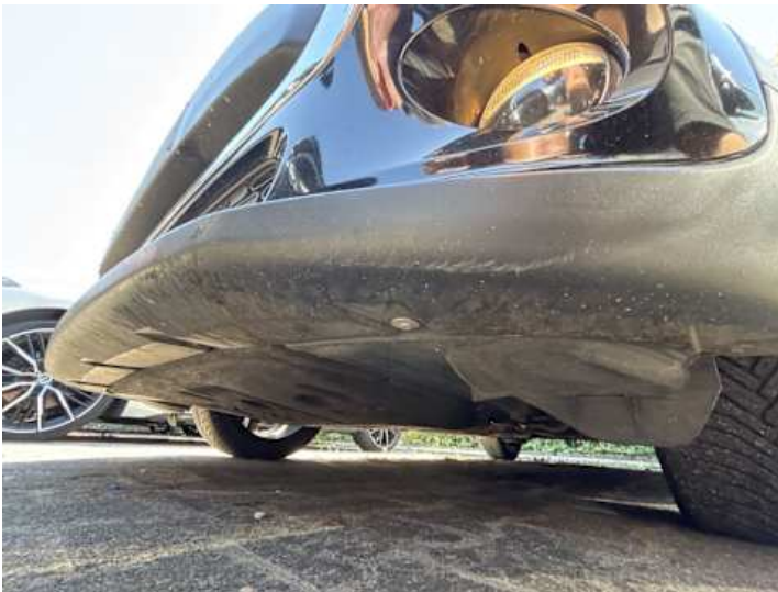
Stoßstange vorne (Kratzer, Riss/Bruch)
