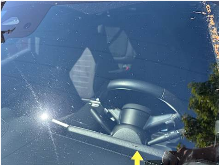
Windschutzscheibe (Steinschlag, Riss/Bruch)
