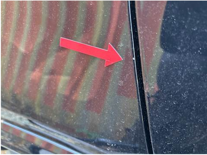
Seitenteil hinten rechts (Lackschaden)
