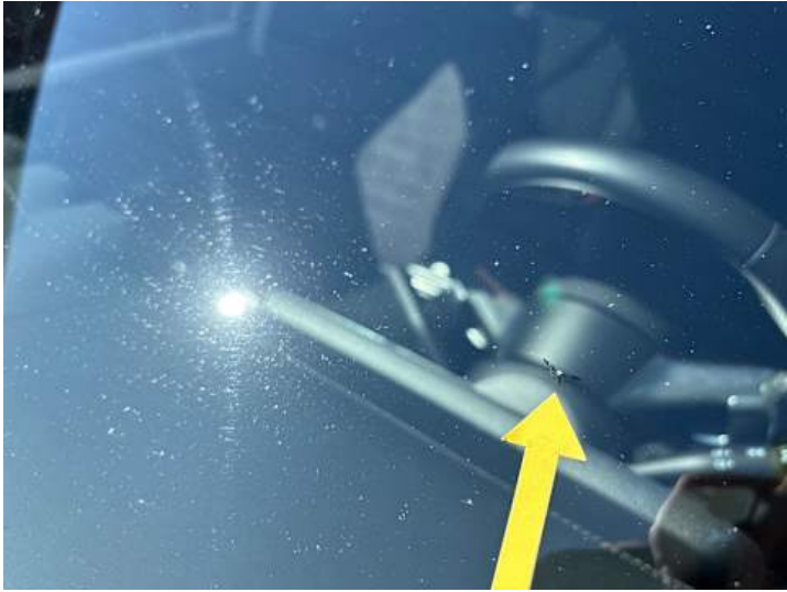
Windschutzscheibe (Steinschlag, Riss/Bruch)
