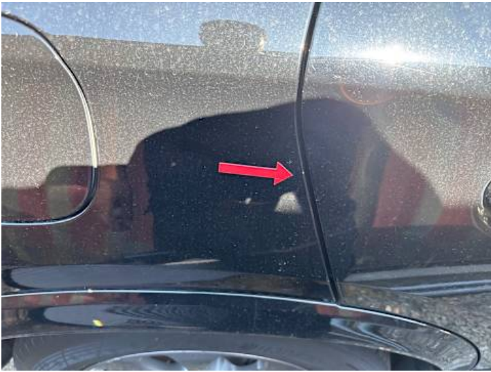
Seitenteil hinten rechts (Lackschaden)
