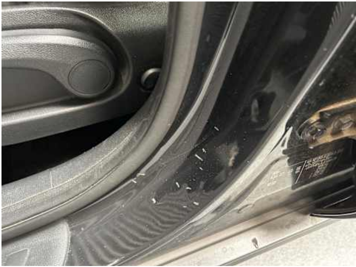
Schweller links (Delle, Kratzer)
