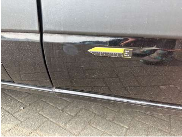
Seitenteil hinten links (Unsachgemäß instand gesetzt)
