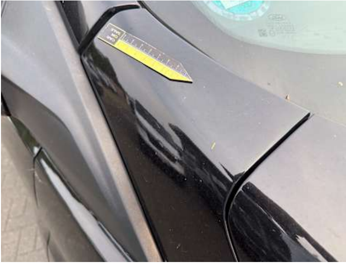
Kotflügel vorne rechts (Steinschlag)
