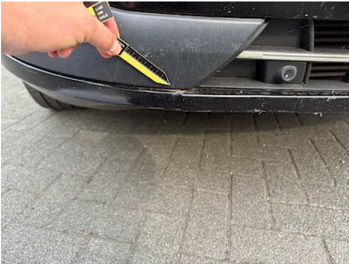
Stoßstange vorne (Riss/Bruch)
