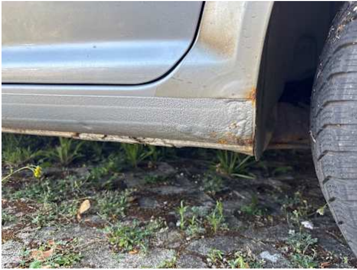
Schweller links (Rost)
