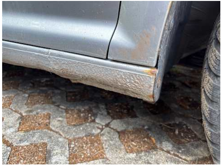
Schweller rechts (Rost)
