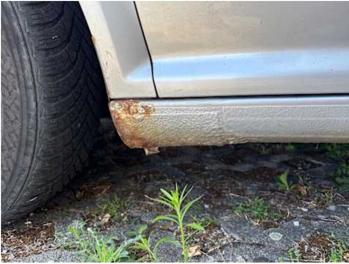
Schweller links (Rost)
