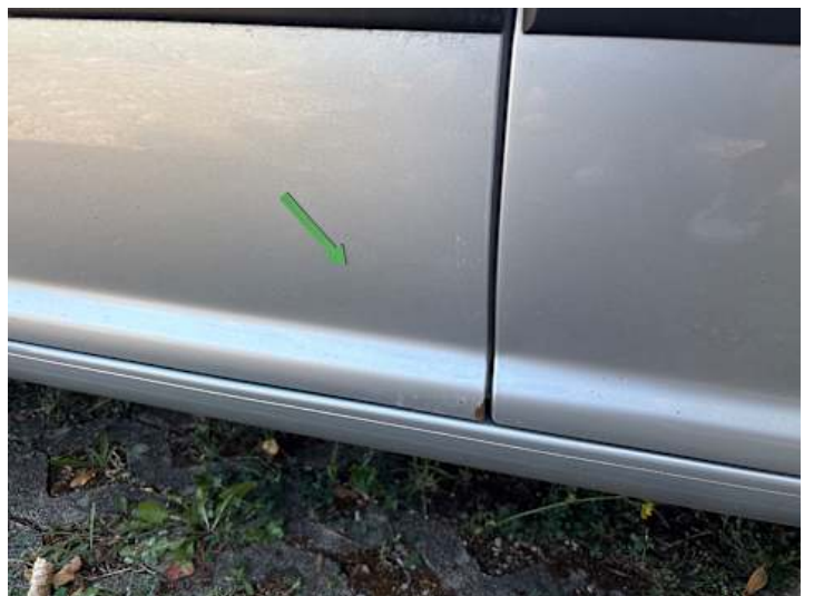
Fahrtür (Kratzer, Rost)
