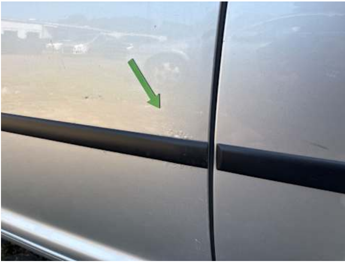
Fahrtür (Kratzer, Rost)
