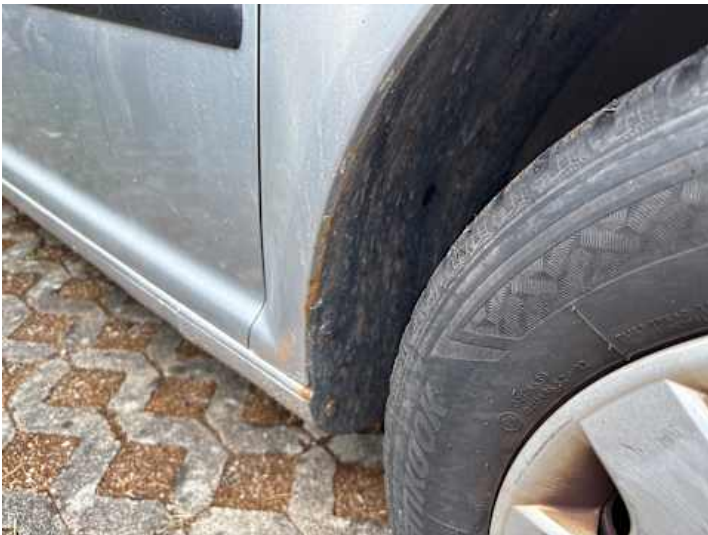
Kotflügel vorne rechts (Lackschaden, Rost)
