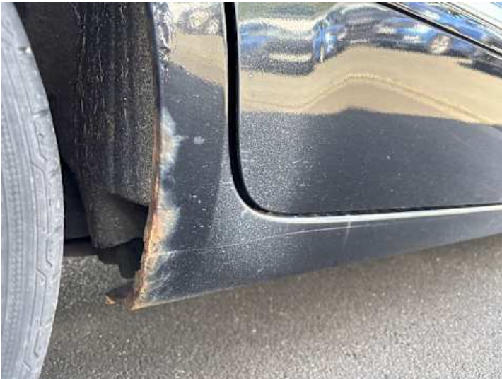
Schweller rechts (Rost)
