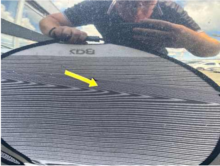
Türe hinten rechts (Delle)
