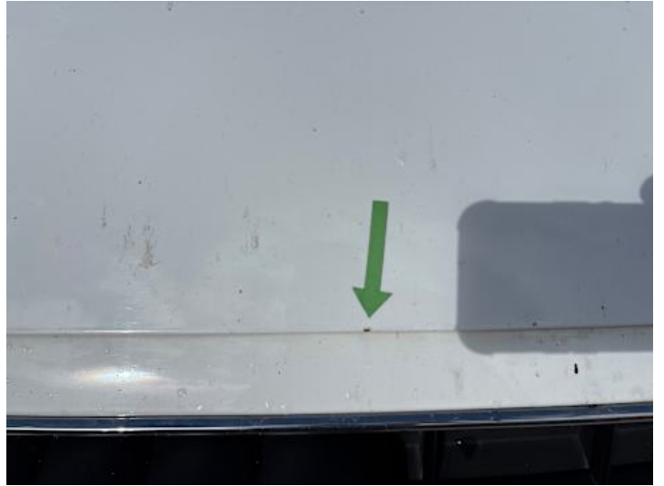
Motorhaube (Rost, Steinschlag)
