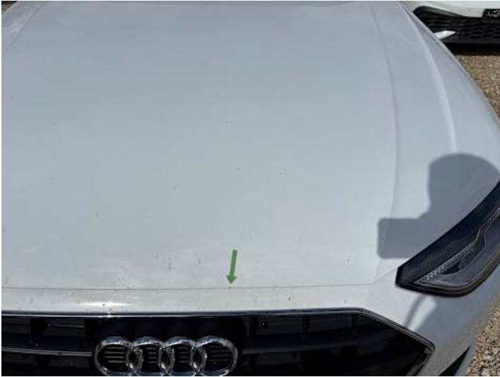
Motorhaube (Rost, Steinschlag)
