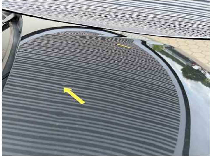
Motorhaube (Anderer Schaden): Hagelschaden
