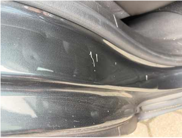
Schweller rechts (Delle, Lackschaden)
