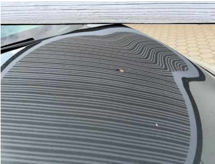
Motorhaube (Anderer Schaden): Hagelschaden
