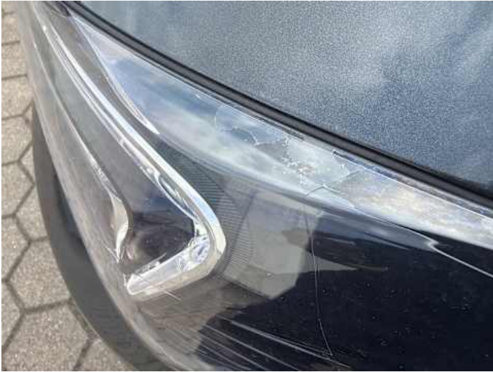
Scheinwerfer (links) (Anderer Schaden): Beschichtung löst sich
