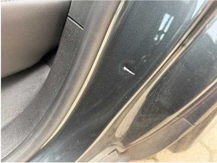
Schweller links (Delle, Lackschaden)
