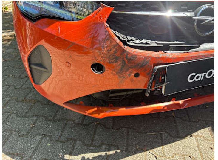
Stoßstange vorne (Kratzer, Riss/Bruch, Verformung)
