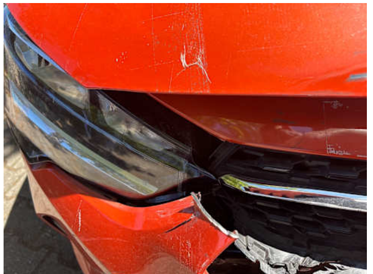
Scheinwerfer (rechts) (Riss/Bruch)
