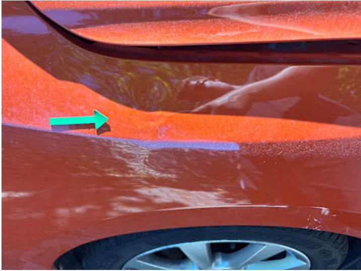
Kotflügel vorne rechts (Verformung, Delle)
