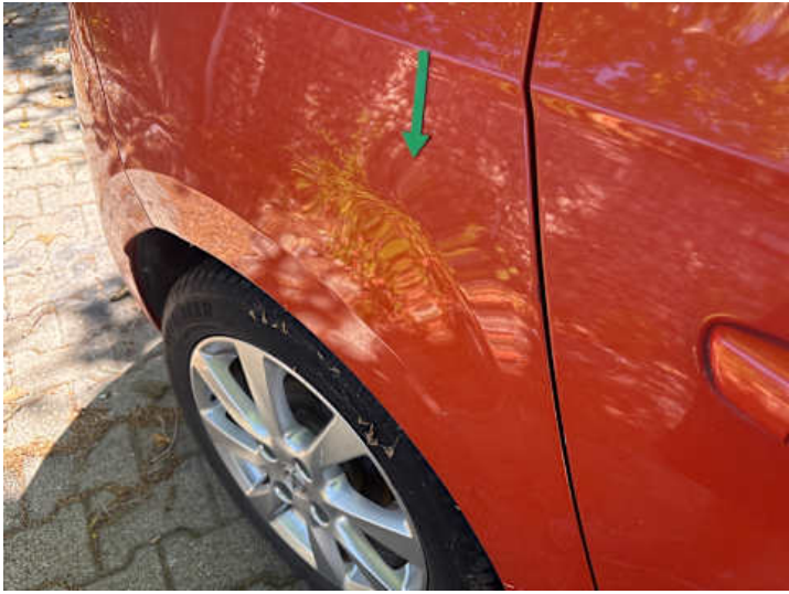
Seitenteil hinten rechts (Verformung)
