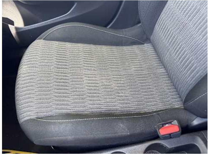
Innenraum (Verschmutzung, Verschleiß)
