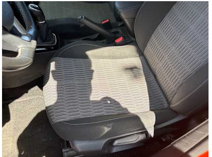
Innenraum (Verschmutzung, Verschleiß)
