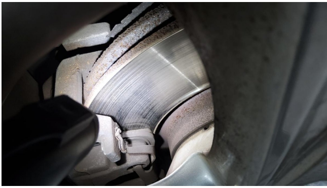
H. Bremse V augenscheinlich nahe Verschleißgrenze (REPARIERT)
