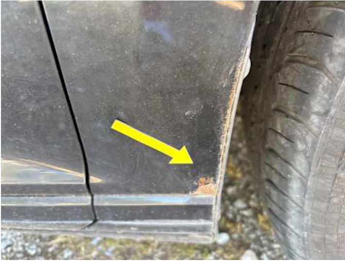
Kotflügel vorne rechts (Rost)
