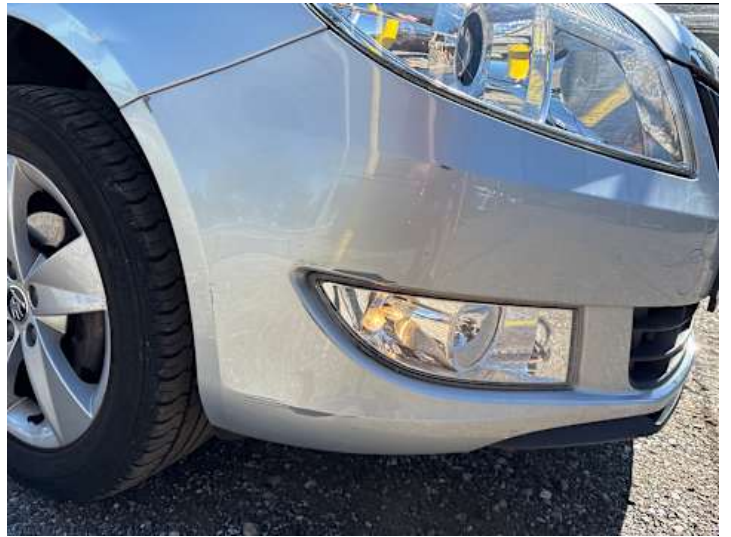
Stoßstange vorne (Kratzer, Lackschaden)
