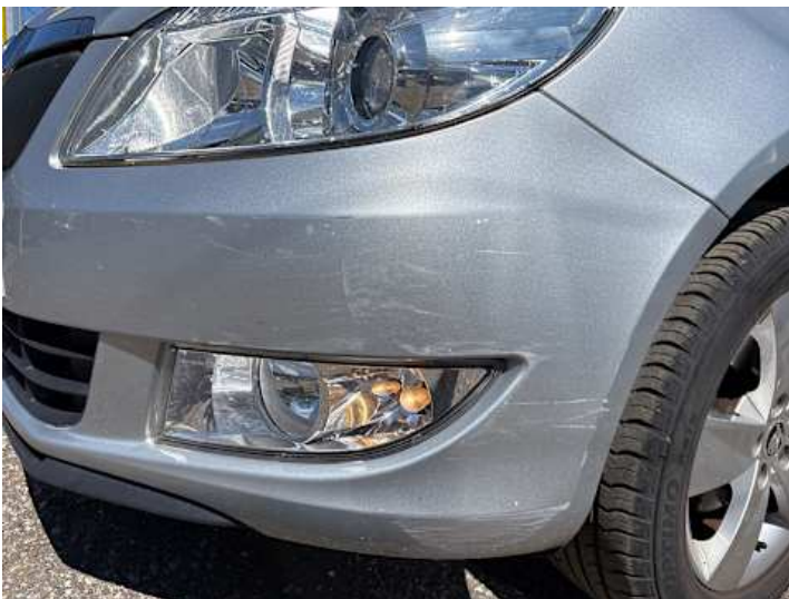
Stoßstange vorne (Kratzer, Lackschaden)
