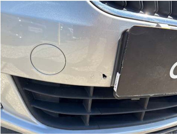
Stoßstange vorne (Riss/Bruch)
