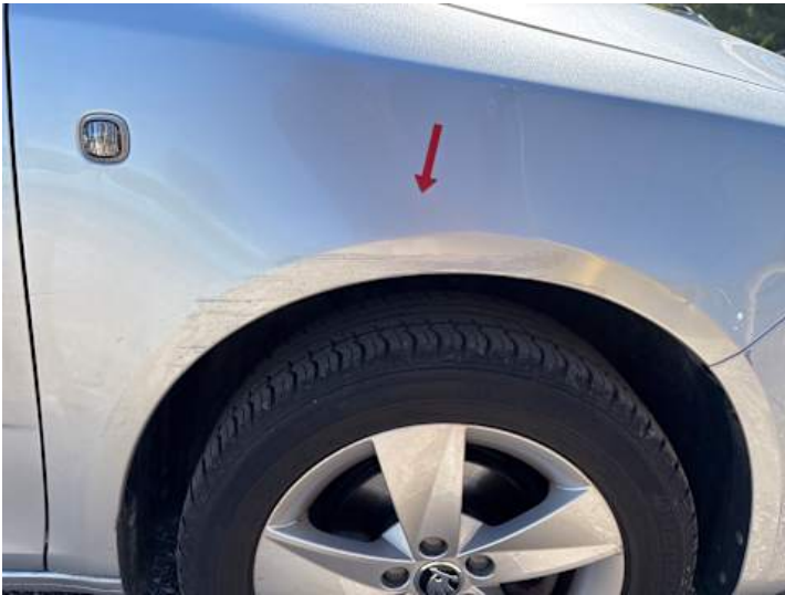
Kotflügel vorne rechts (Kratzer, Lackschaden)
