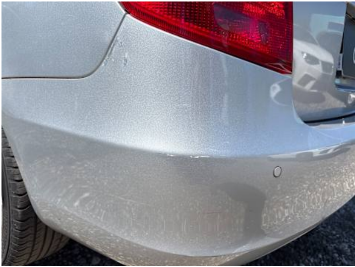
Stoßstange hinten (Kratzer, Lackschaden)
