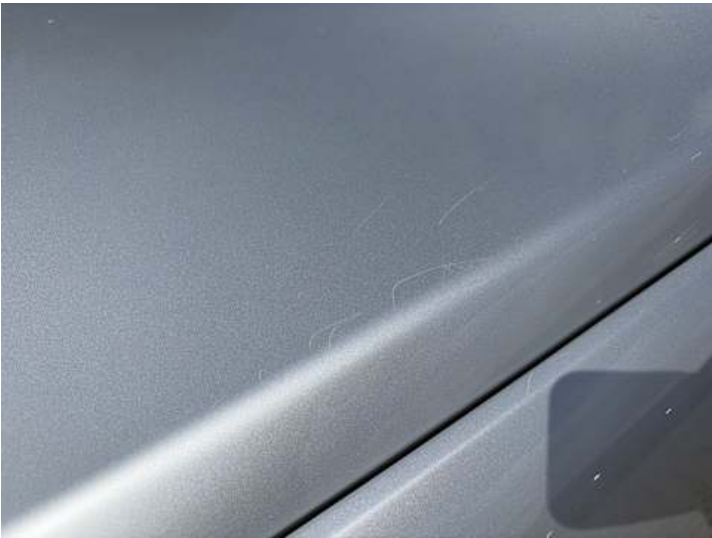
Motorhaube (Kratzer, Lackschaden, Steinschlag)
