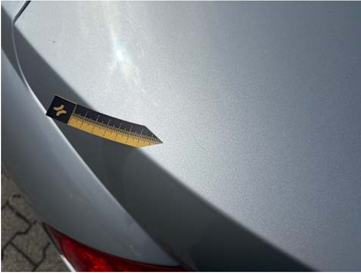
Heckklappe (Kratzer, Lackschaden)
