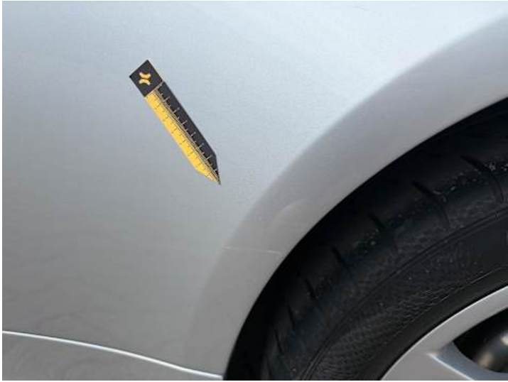
Seitenteil hinten links (Kratzer, Lackschaden)
