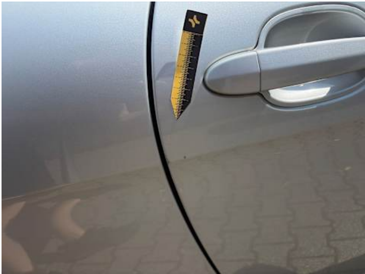
Beifahrertür (Kratzer, Lackschaden)
