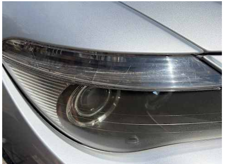
Scheinwerfer (rechts) (Undicht, Riss/Bruch)
