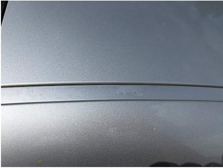
Dach (Lackschaden, Delle)
