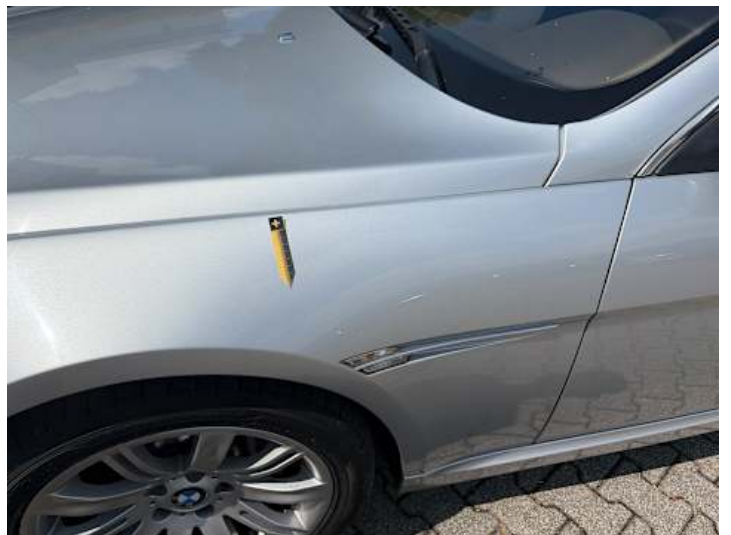
Kotflügel vorne links (Kratzer)
