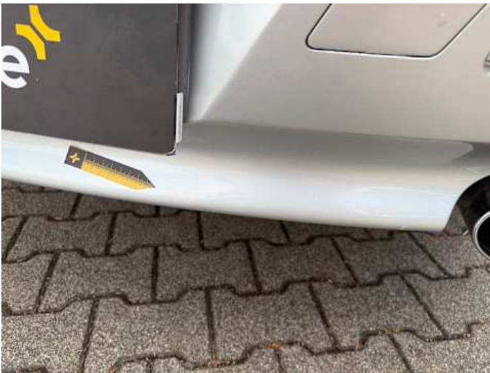
Stoßstange hinten (Lackschaden, Kratzer, Unsachgemäß instand gesetzt)
