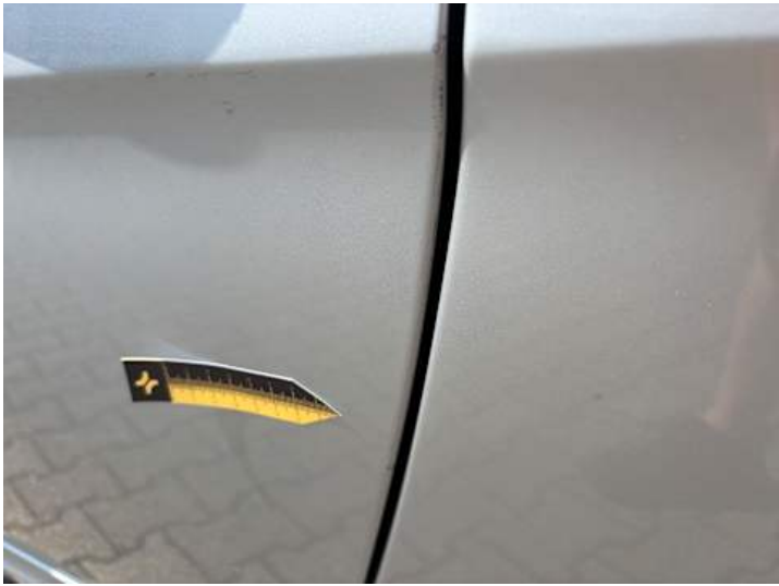
Fahrrertür (Kratzer, Lackschaden)
