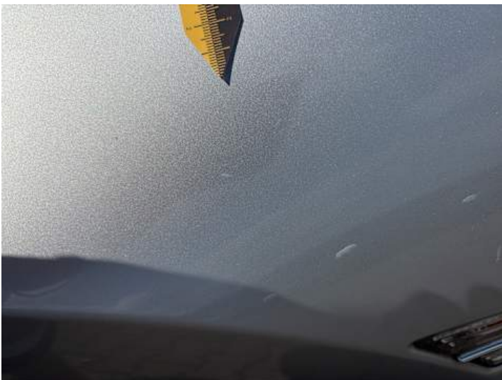
Kotflügel vorne links (Kratzer)
