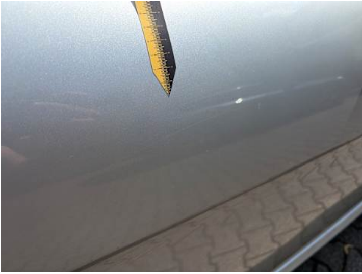
Beifahrertür (Kratzer, Lackschaden)
