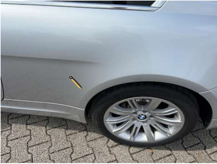
Seitenteil hinten links (Kratzer, Lackschaden)
