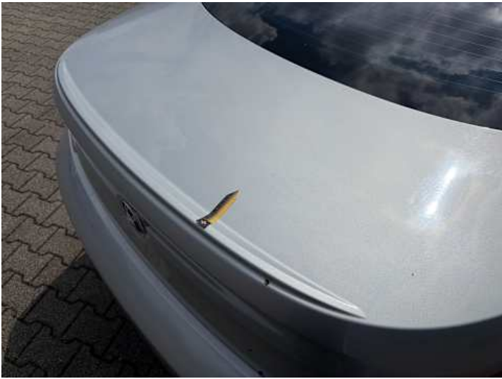
Heckklappe (Kratzer, Lackschaden)
