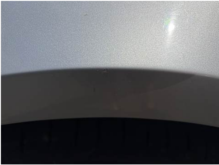
Kotflügel vorne rechts (Lackschaden, Steinschlag)
