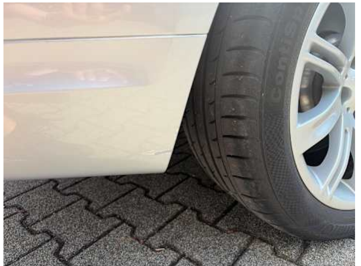
Stoßstange hinten (Lackschaden, Kratzer, Unsachgemäß instand gesetzt)
