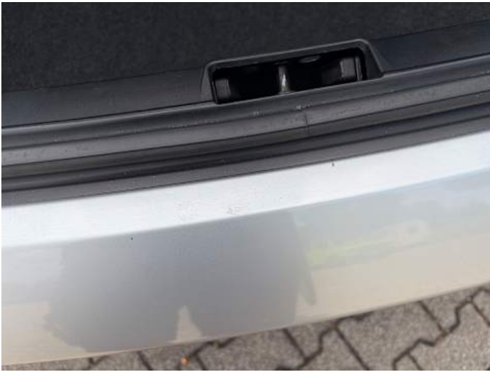
Stoßstange hinten (Lackschaden, Kratzer, Unsachgemäß instand gesetzt)
