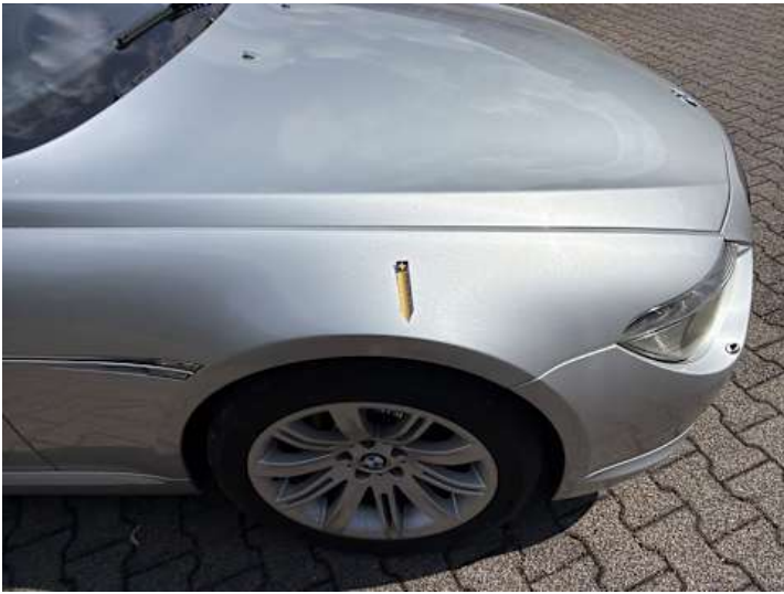
Kotflügel vorne rechts (Lackschaden, Steinschlag)
