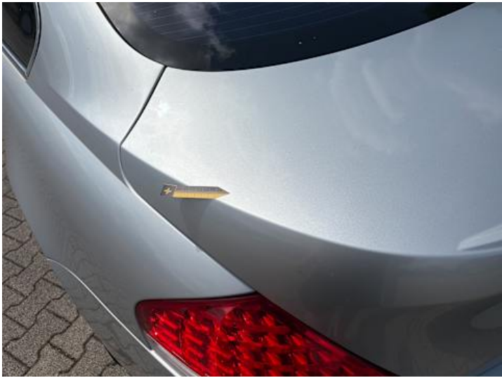
Heckklappe (Kratzer, Lackschaden)
