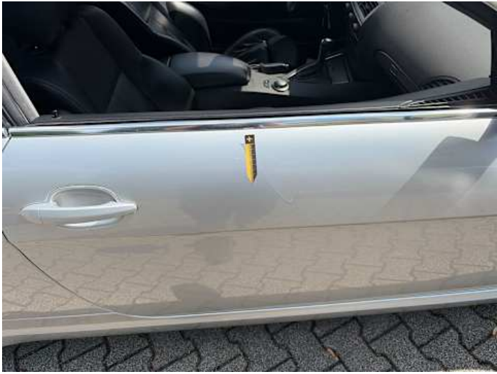
Beifahrertür (Kratzer, Lackschaden)
