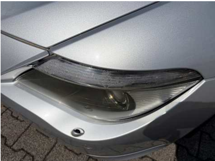
Scheinwerfer (links) (Undicht)
