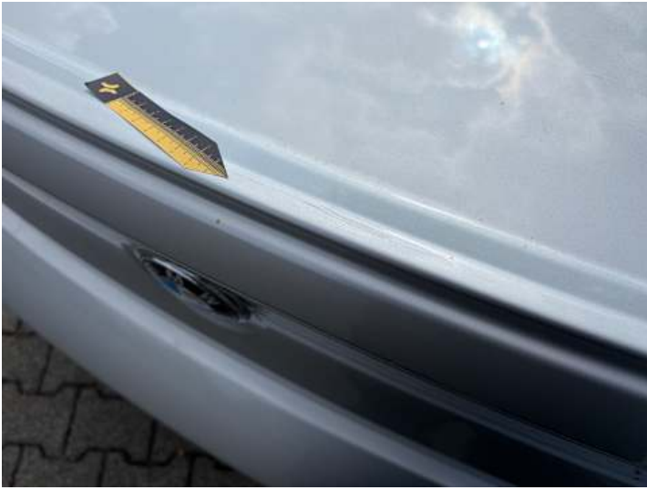
Heckklappe (Kratzer, Lackschaden)
