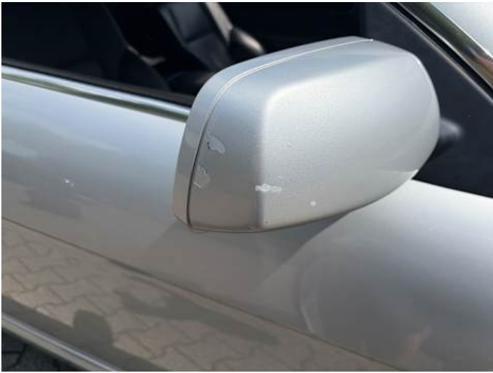
Beifahrertür (Kratzer, Lackschaden)
