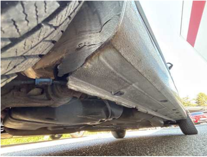
Schweller rechts (Rost)
