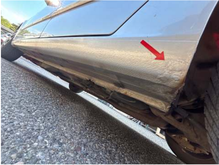
Schweller links (Rost)
