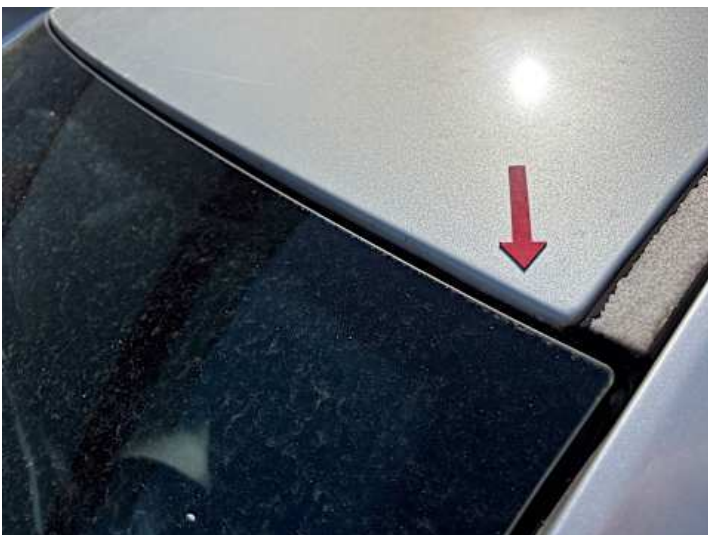
Dach (Lackschaden, Rost)
