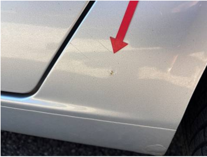
Seitenteil hinten links (Rost)
