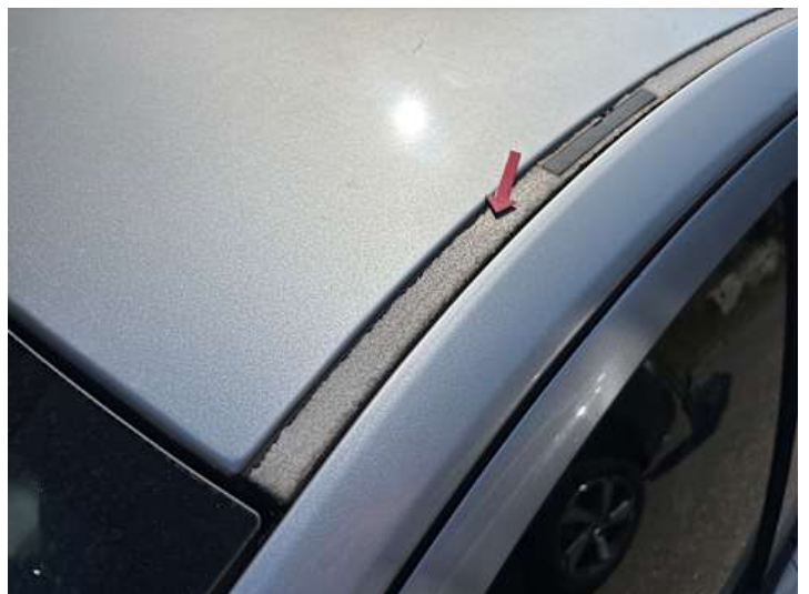
Dach (Lackschaden, Rost)
