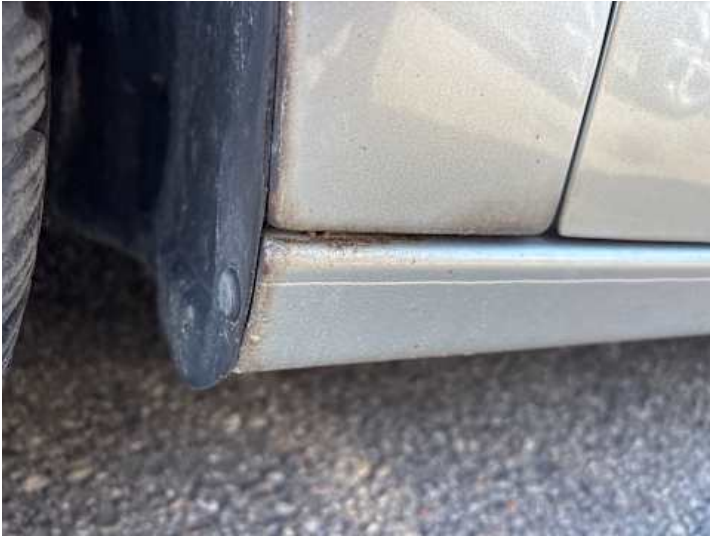
Schweller links (Rost)
