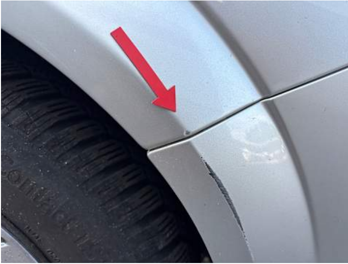
Kotflügel vorne rechts (Kratzer, Lackschaden)
