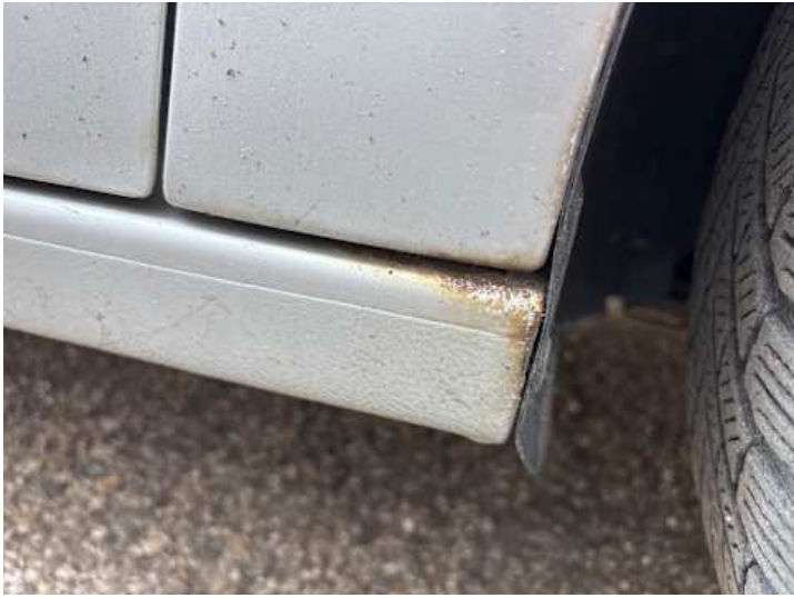
Schweller rechts (Rost)
