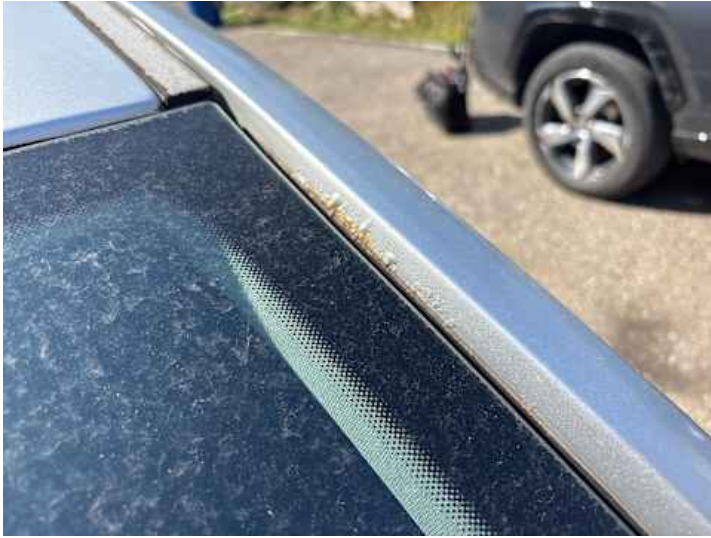
Seitenteil hinten links (Rost)
