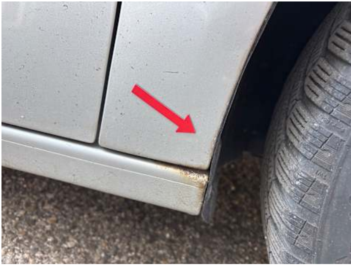
Kotflügel vorne rechts (Rost)
