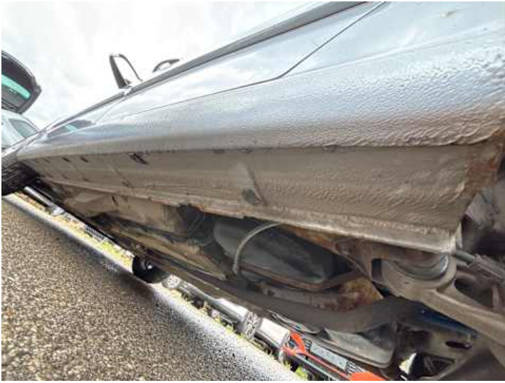
Schweller links (Rost)
