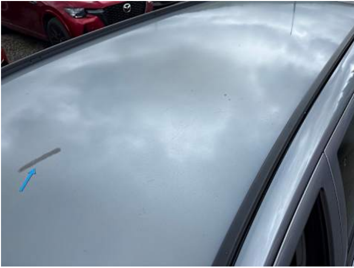
Dach (Ausgeblichen/Matt, Lackschaden)
