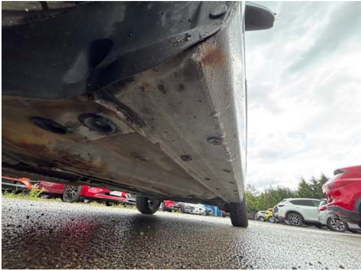
Schweller links (Rost)
