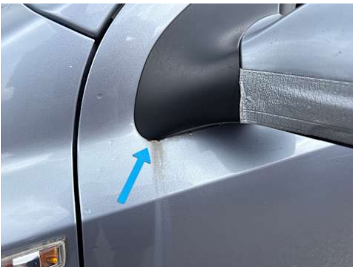
Fahrertür (Unsachgemäß instand gesetzt, Rost)
