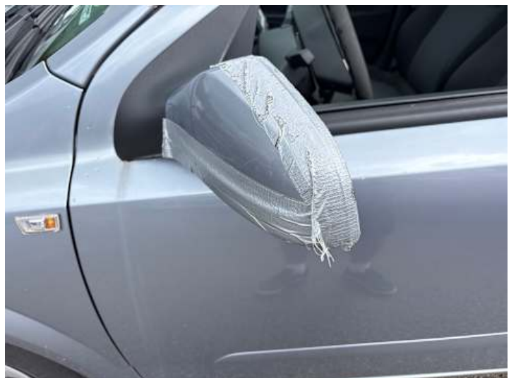
Fahrertür (Unsachgemäß instand gesetzt, Rost)
