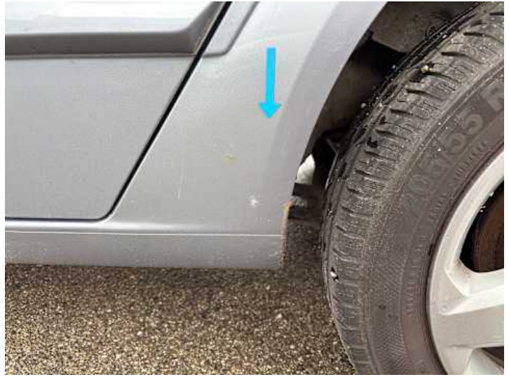
Seitenteil hinten links (Rost)
