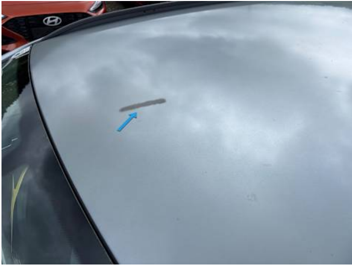
Dach (Ausgeblichen/Matt, Lackschaden)
