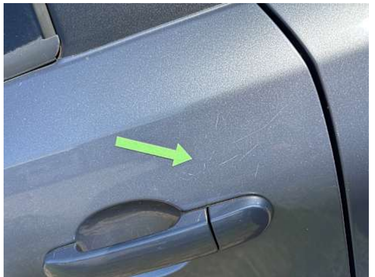
Türe hinten links (Kratzer)
