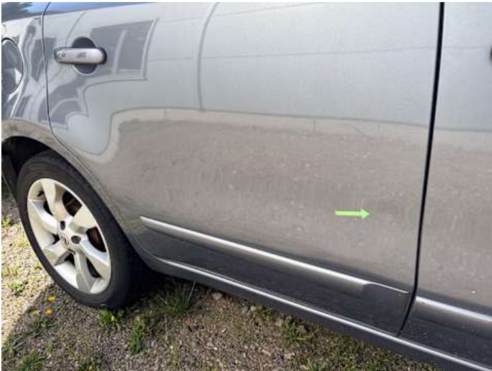
Türe hinten rechts (Kratzer, Delle)
