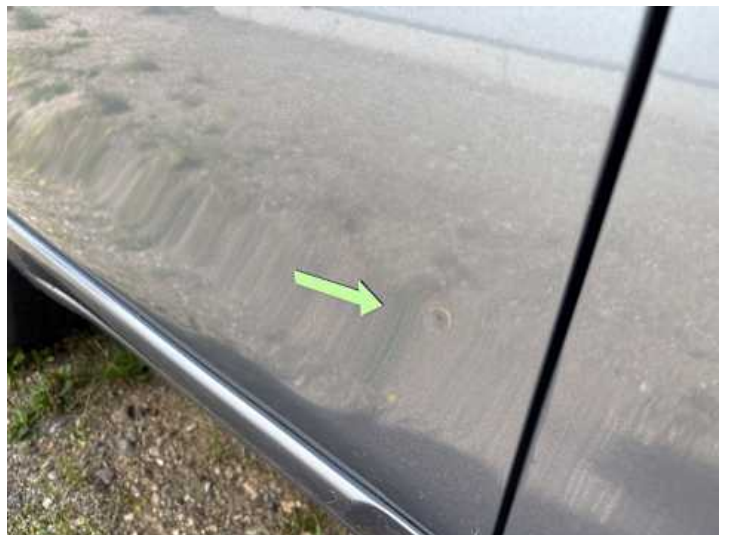
Türe hinten rechts (Kratzer, Delle)
