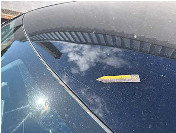
Dach (Lackschaden, Kratzer)
