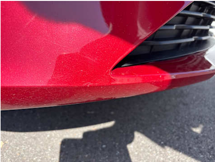
Stoßstange vorne (Riss/Bruch)
