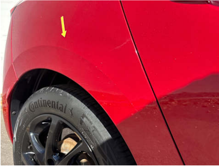
Seitenteil hinten rechts (Lackschaden, Delle)
