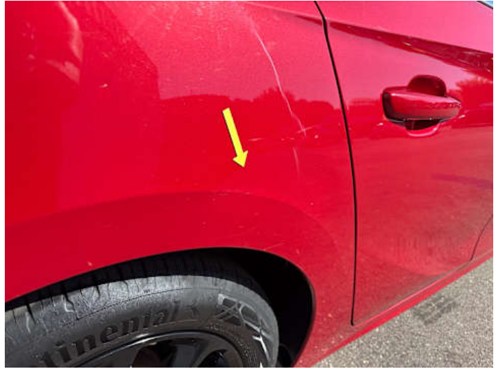
Seitenteil hinten rechts (Lackschaden, Delle)
