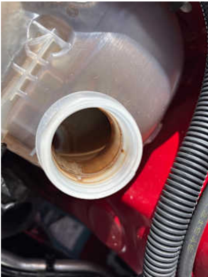
Motorhaube (Anderer Schaden): Kühkwasser Ölig/Braun
