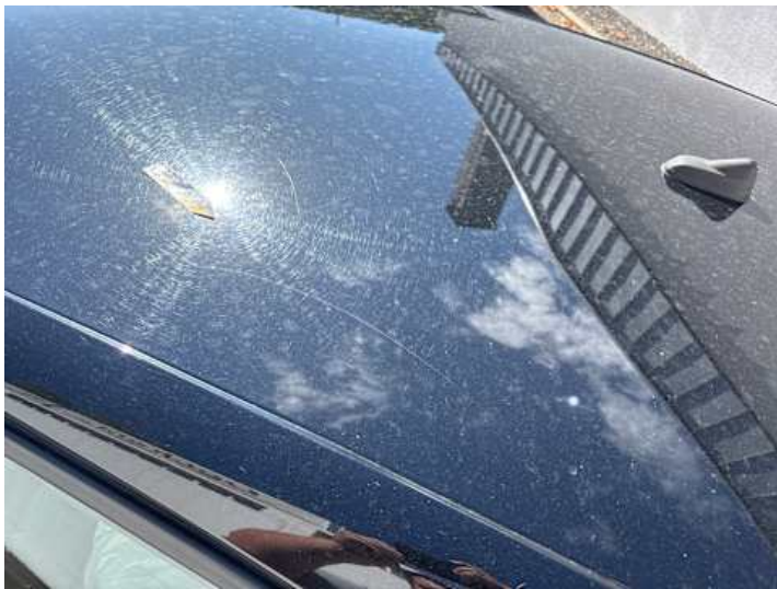
Dach (Lackschaden, Kratzer)
