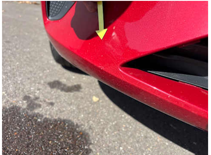
Stoßstange vorne (Riss/Bruch)
