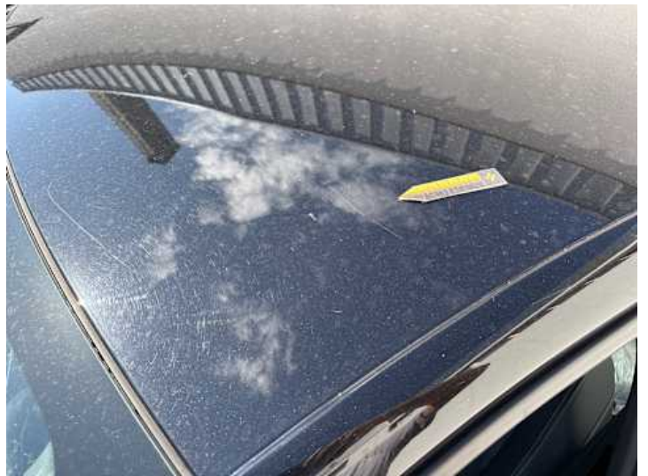
Dach (Lackschaden, Kratzer)
