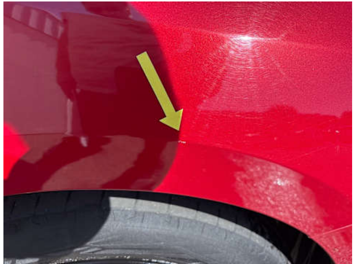
Kotflügel vorne rechts (Lackschaden)
