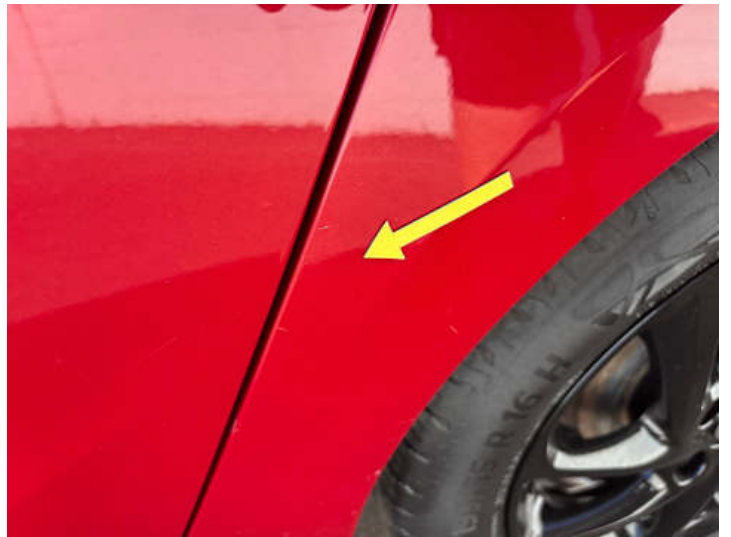
Seitenteil hinten links (Lackschaden, Kratzer)
