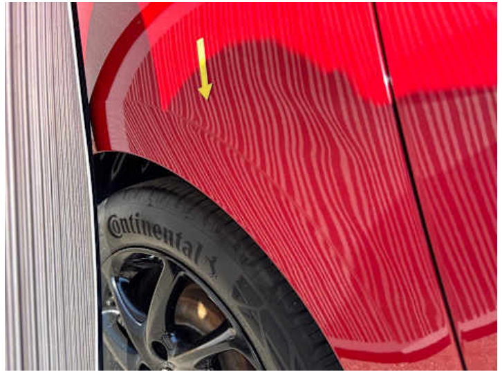
Seitenteil hinten rechts (Lackschaden, Delle)
