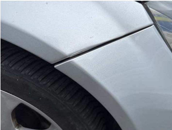
Stoßstange vorne (Spaltmaße ungenau)
