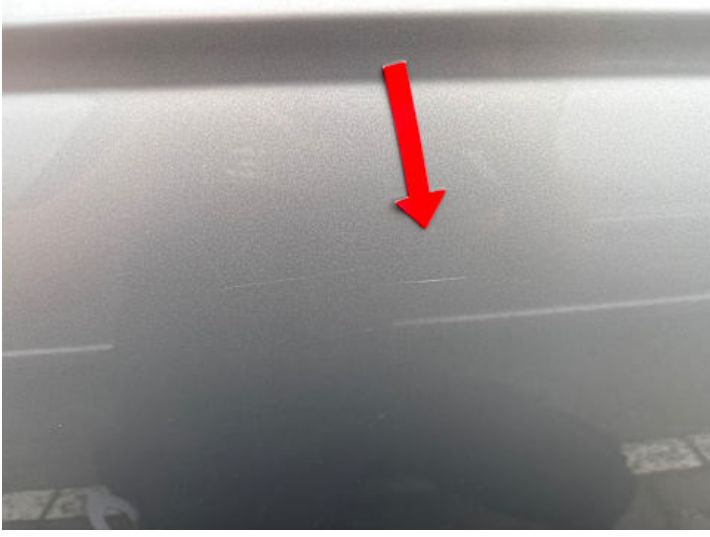
Türe hinten rechts (Kratzer, Lackschaden)
