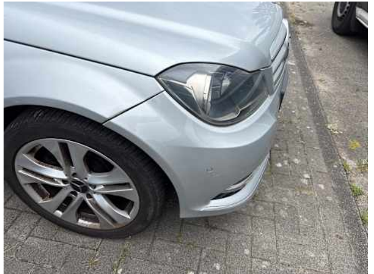
Stoßstange vorne (Spaltmaße ungenau)
