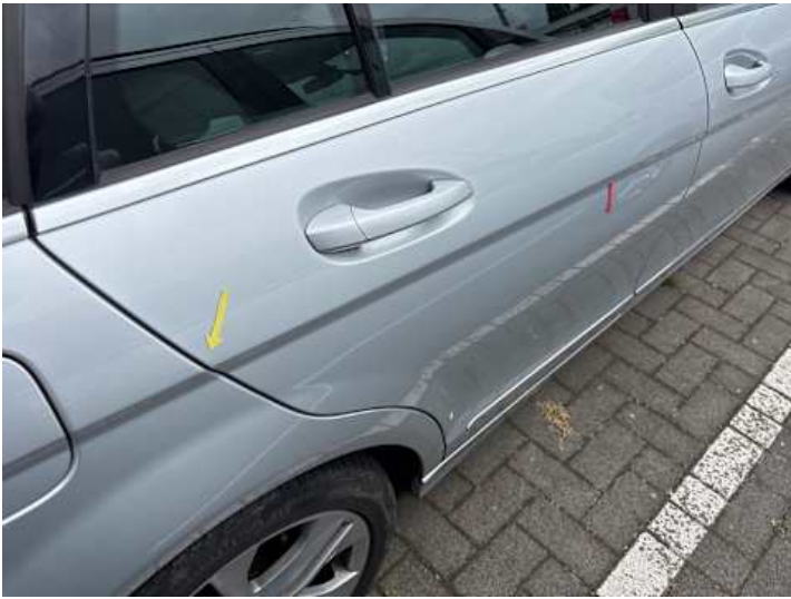
Türe hinten rechts (Kratzer, Lackschaden)
