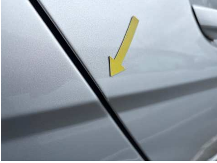
Türe hinten rechts (Kratzer, Lackschaden)
