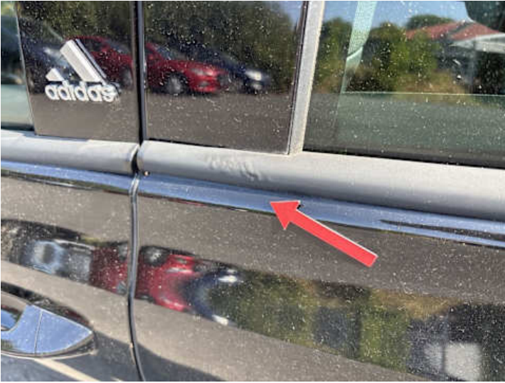
Türe hinten links (Rost)
