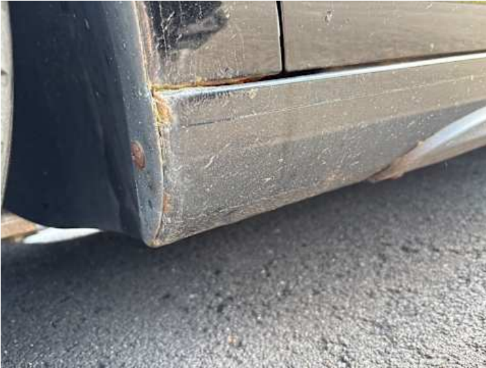
Schweller links (Rost)
