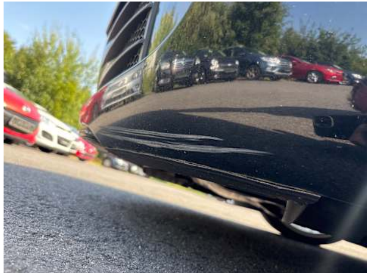
Stoßstange vorne (Kratzer, Lackschaden)
