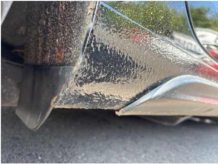
Schweller rechts (Rost)
