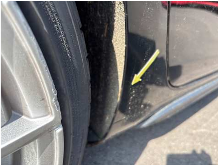
Seitenteil hinten rechts (Rost)
