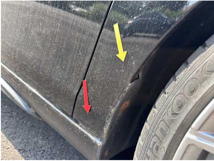
Kotflügel vorne rechts (Rost)
