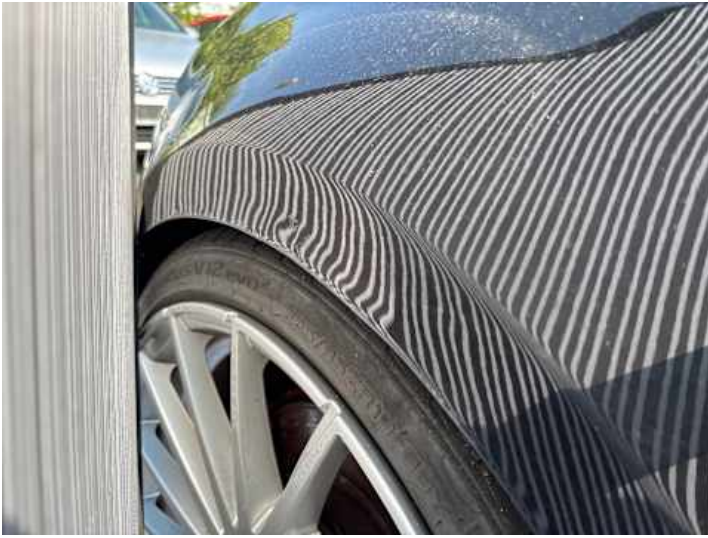
Kotflügel vorne links (Verformung)
