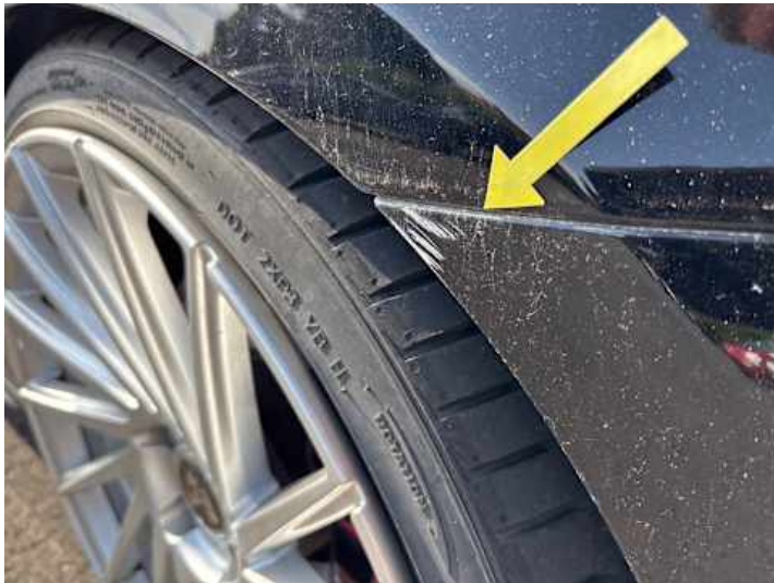
Stoßstange vorne (Kratzer, Lackschaden)
