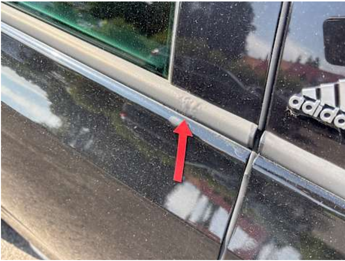
Türe hinten rechts (Rost)
