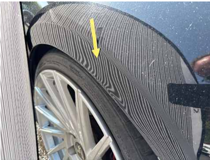
Kotflügel vorne rechts (Verformung)
