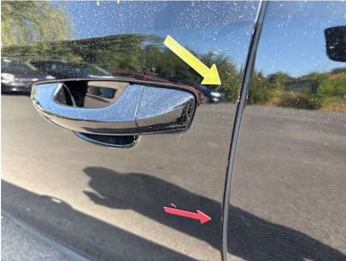
Fahrtür (Lackschaden, Rost)
