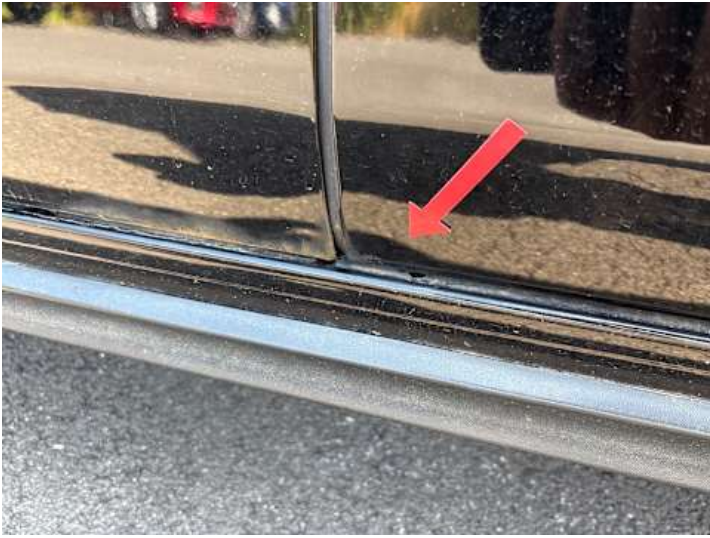
Türe hinten links (Rost)
