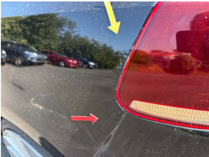
Seitenteil hinten links (Rost)
