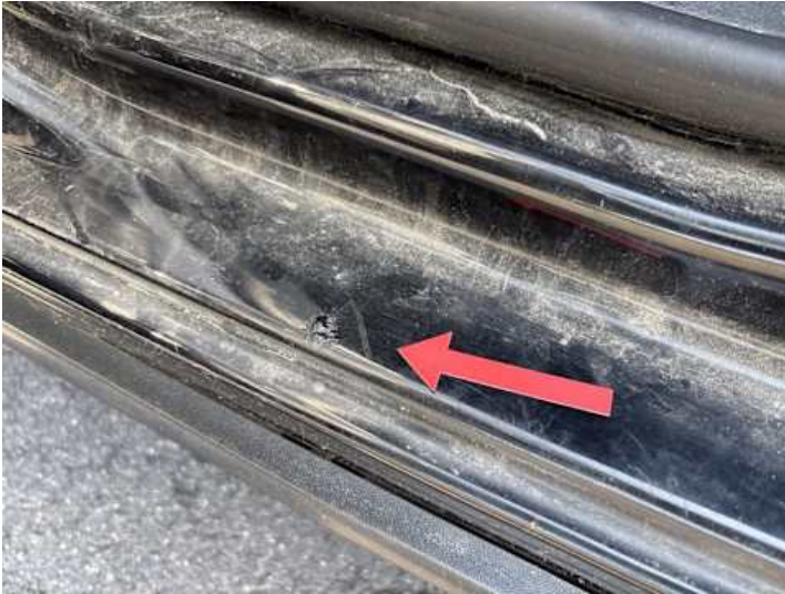
Schweller links (Rost)
