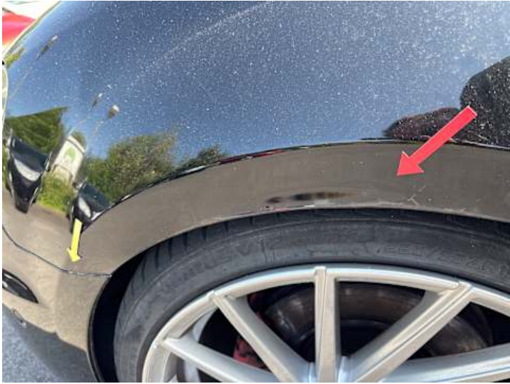
Kotflügel vorne links (Rost)
