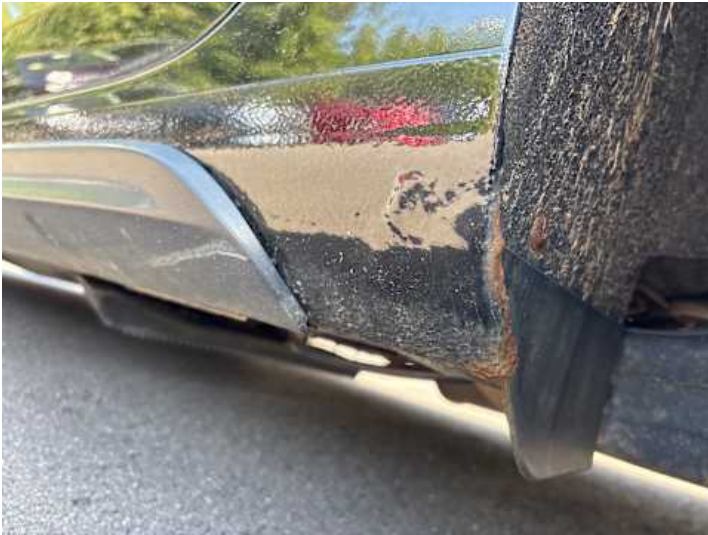
Schweller links (Rost)
