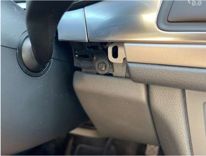
Innenraum (Anderer Schaden): Abdeckung fehlt
