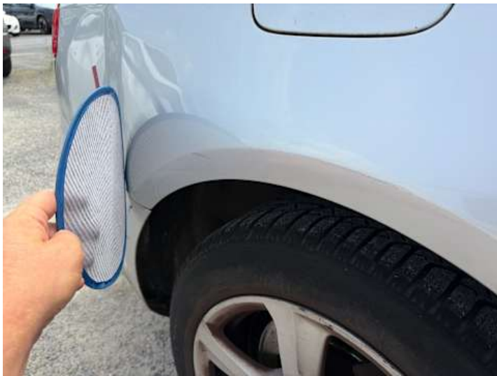
Seitenteil hinten rechts (Kratzer, Delle)
