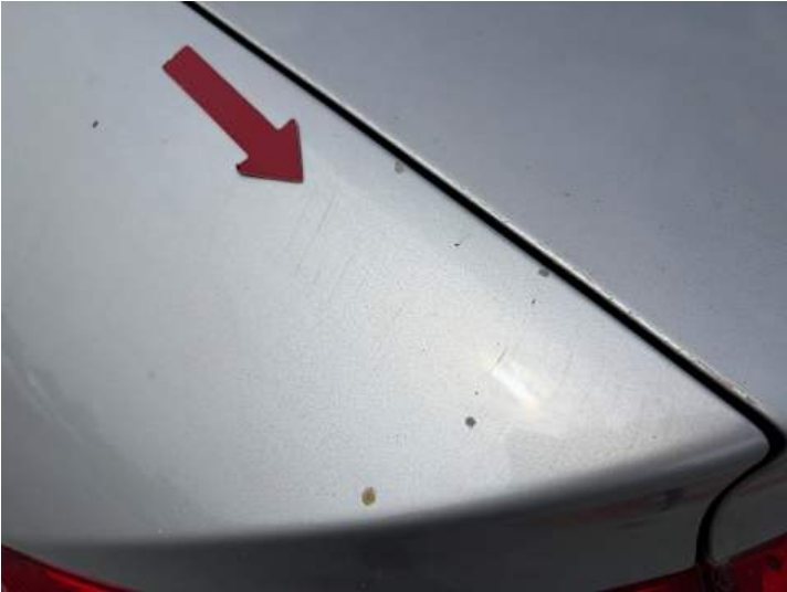
Seitenteil hinten links (Kratzer, Delle)
