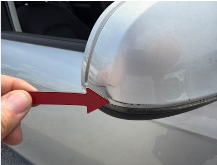
Beifahrertür (Kratzer, Delle)
