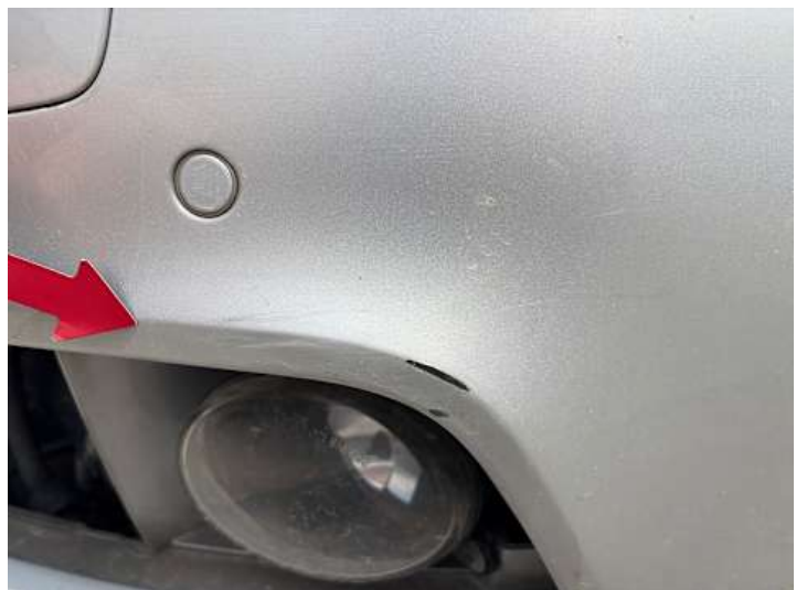
Stoßstange vorne (Kratzer, Verformung)
