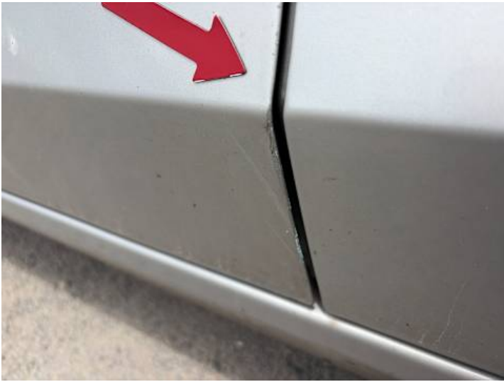
Fahrentür (Kratzer, Delle)
