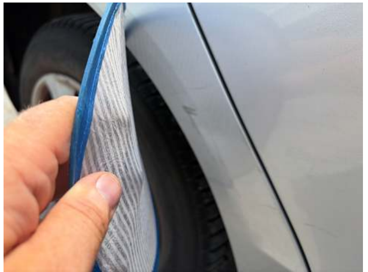
Seitenteil hinten rechts (Kratzer, Delle)
