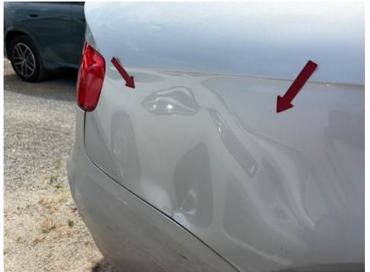
Seitenteil hinten rechts (Verformung)
