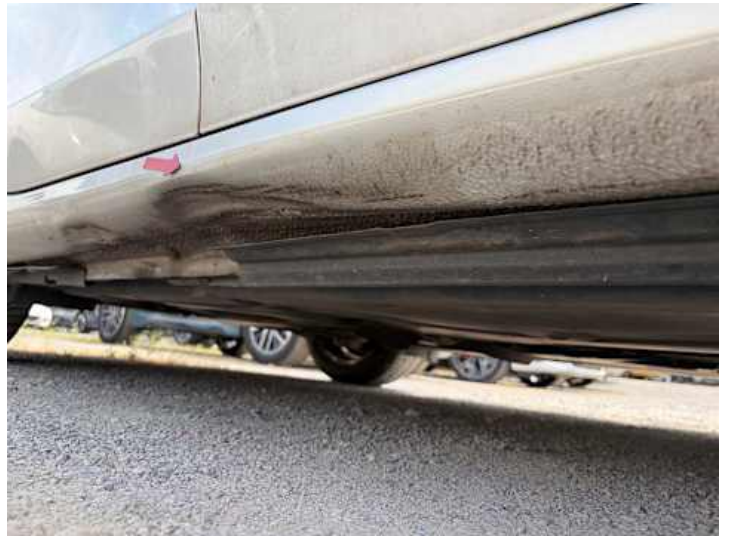
Schweller rechts (Verformung, Kratzer)
