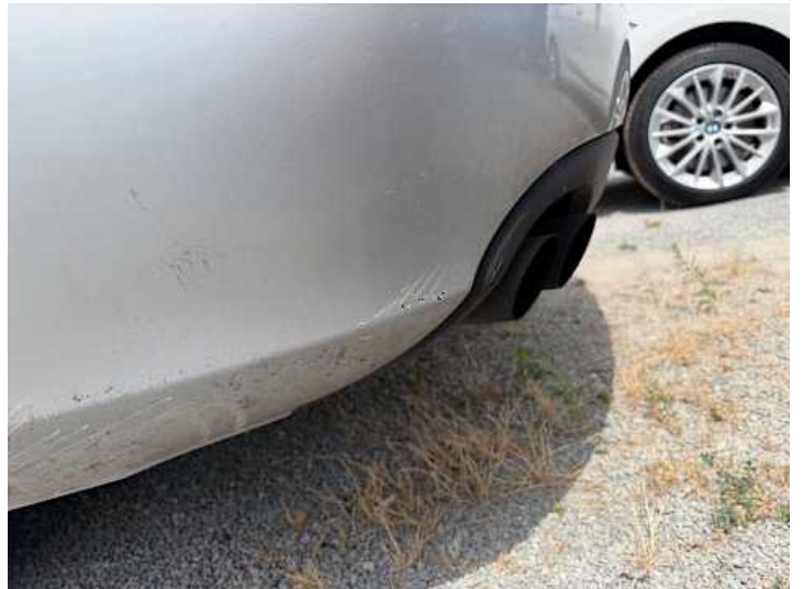
Stoßstange hinten (Verformung, Riss/Bruch)
