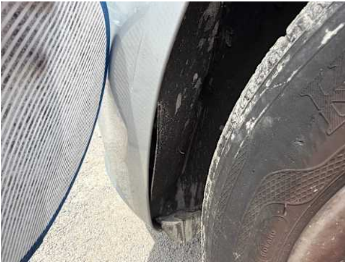
Kotflügel vorne links (Verformung, Kratzer)
