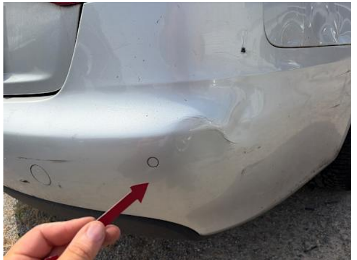
Stoßstange hinten (Verformung, Riss/Bruch)
