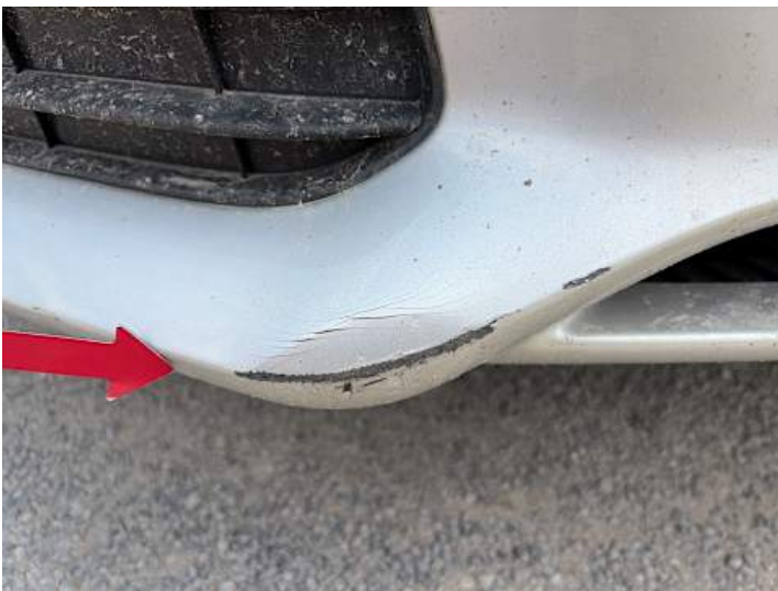
Stoßstange vorne (Kratzer, Verformung)
