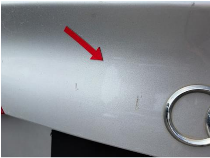
Heckklappe (Kratzer, Delle)
