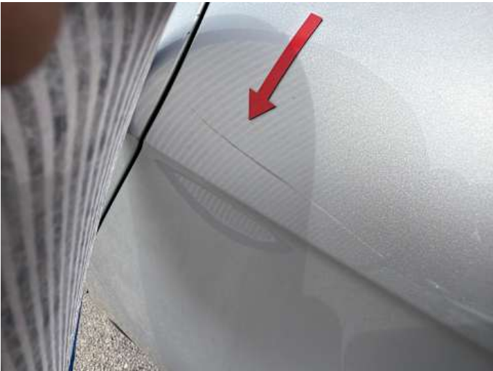
Seitenteil hinten links (Kratzer, Delle)
