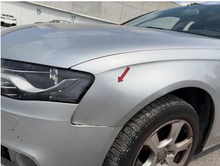
Kotflügel vorne links (Verformung, Kratzer)
