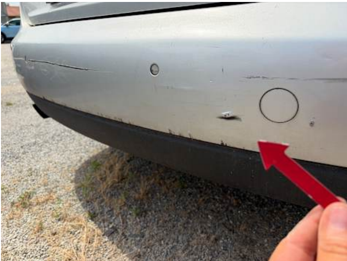
Stoßstange hinten (Verformung, Riss/Bruch)
