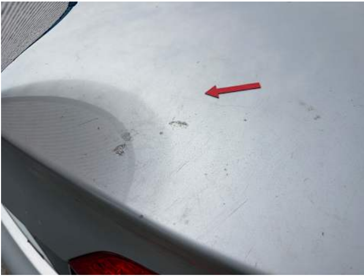
Heckklappe (Kratzer, Delle)
