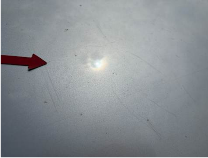
Motorhaube (Kratzer, Steinschlag)
