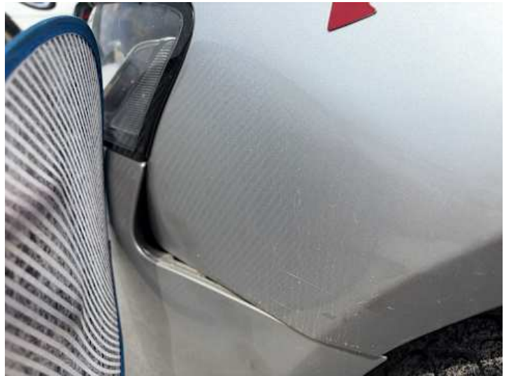
Kotflügel vorne links (Verformung, Kratzer)
