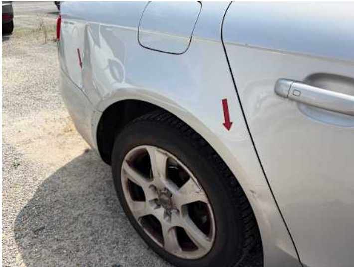
Seitenteil hinten rechts (Kratzer, Delle)
