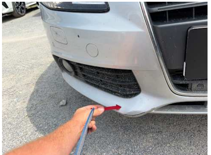
Stoßstange vorne (Kratzer, Verformung)
