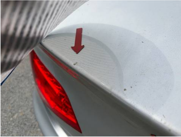
Heckklappe (Kratzer, Delle)
