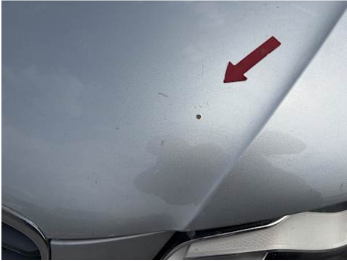
Motorhaube (Kratzer, Steinschlag)
