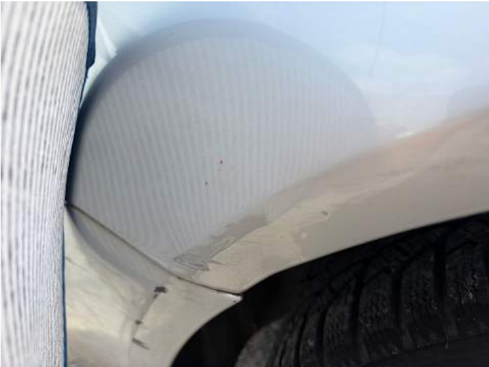
Seitenteil hinten rechts (Kratzer, Delle)
