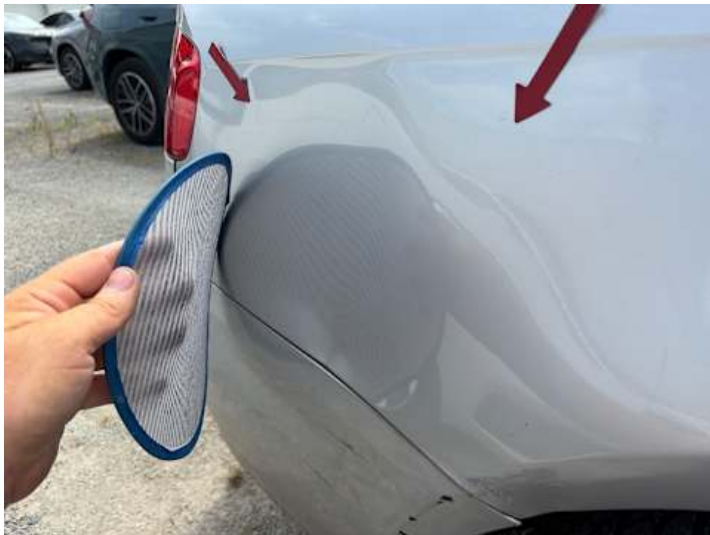
Seitenteil hinten rechts (Verformung)
