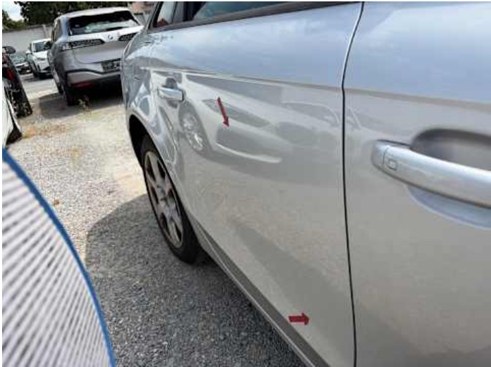
Türe hinten rechts (Kratzer, Delle)
