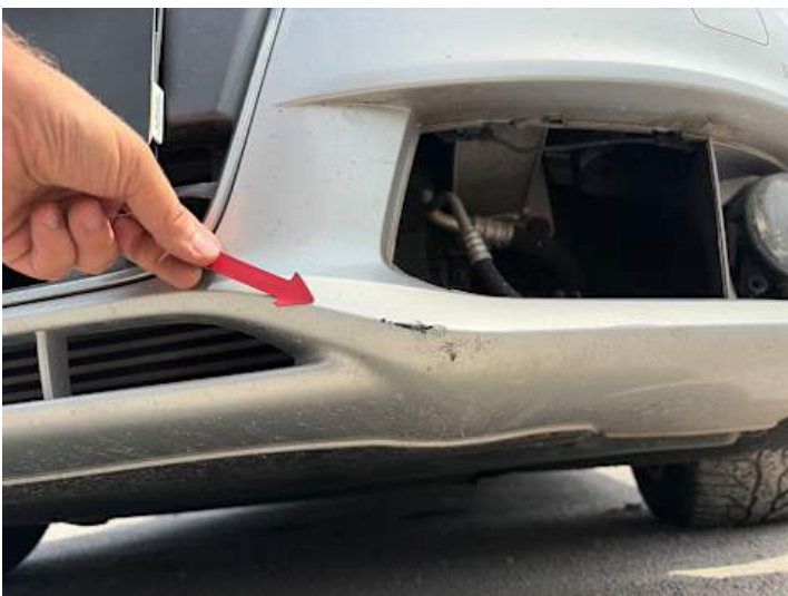
Stoßstange vorne (Kratzer, Verformung)
