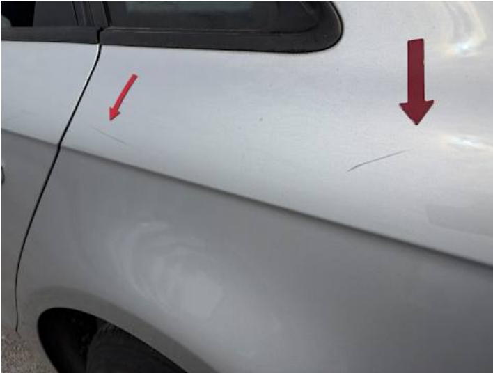
Seitenteil hinten links (Kratzer, Delle)
