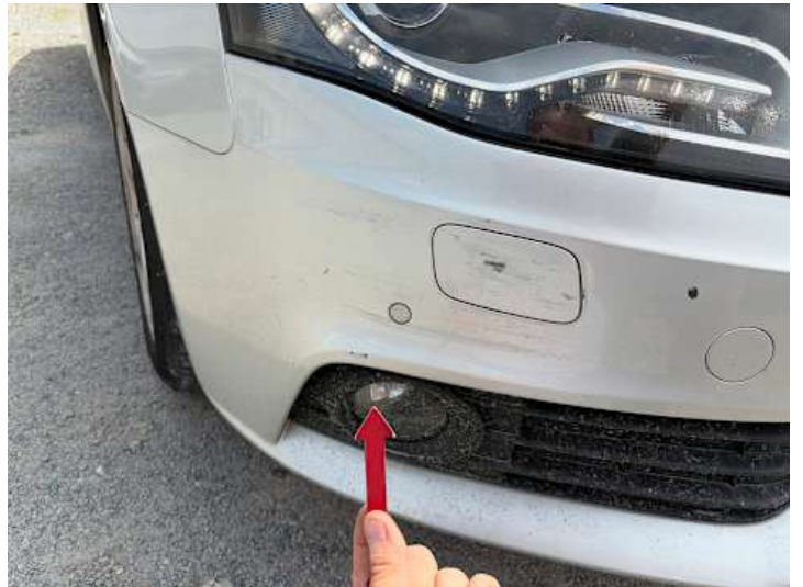
Stoßstange vorne (Kratzer, Verformung)
