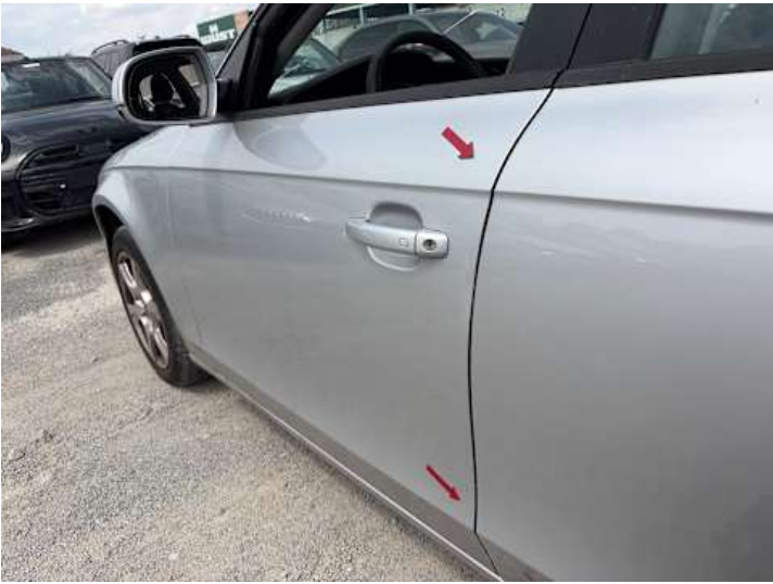
Fahrentür (Kratzer, Delle)
