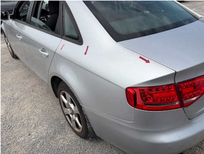
Seitenteil hinten links (Kratzer, Delle)
