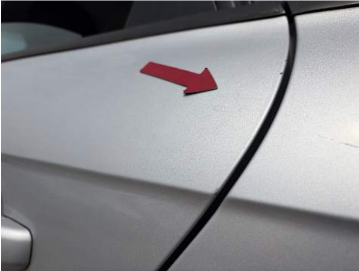
Türe hinten links (Kratzer, Delle)
