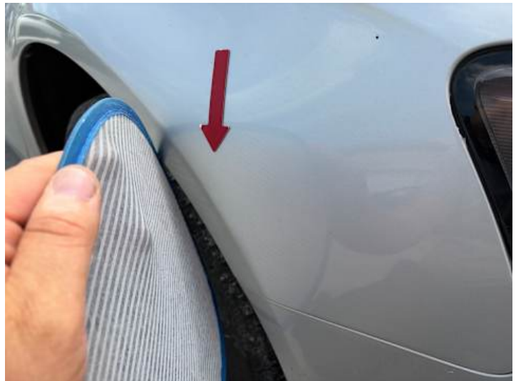
Kotflügel vorne rechts (Kratzer, Delle)
