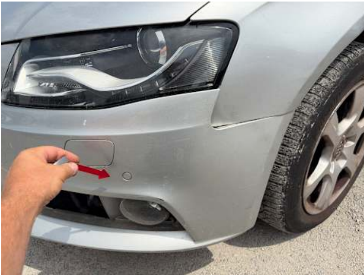
Stoßstange vorne (Kratzer, Verformung)
