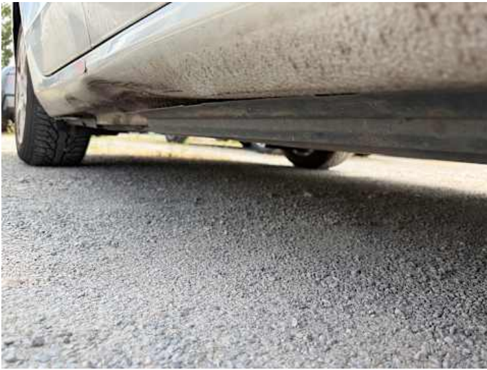
Schweller rechts (Verformung, Kratzer)
