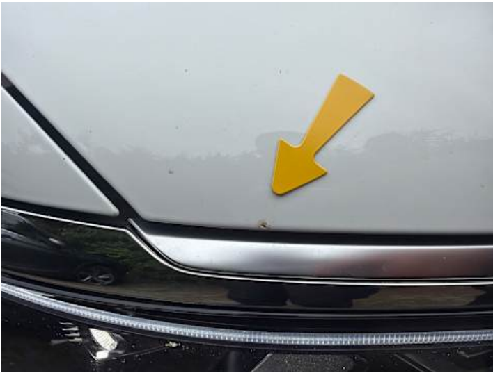
Motorhaube (Steinschlag, Rost)
