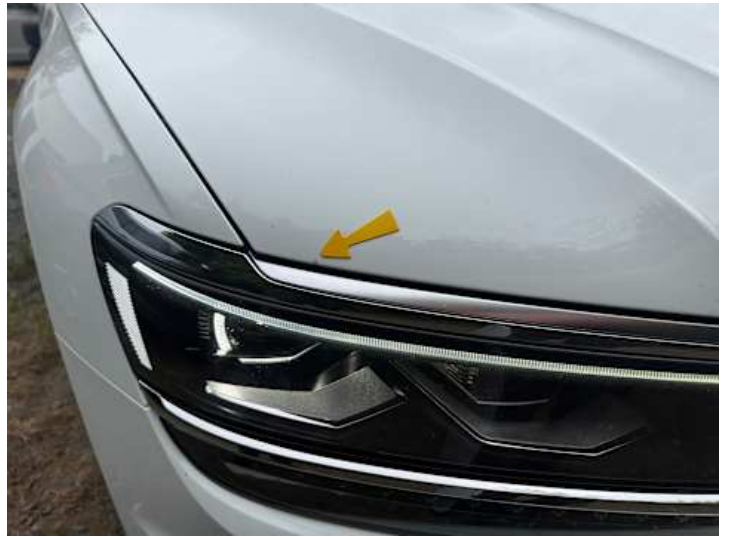
Motorhaube (Steinschlag, Rost)
