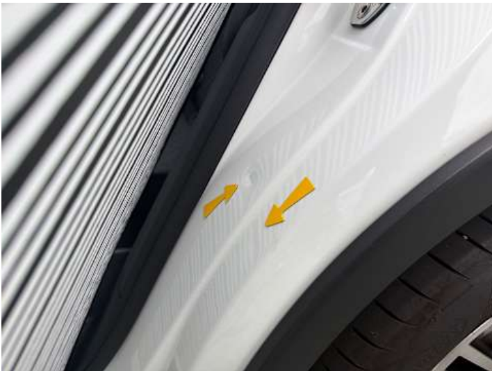
Schweller links (Delle)
