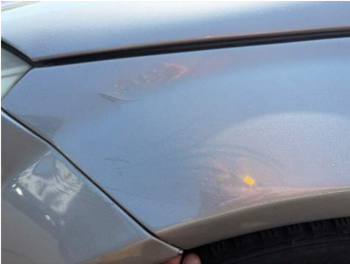
Kotflügel vorne links (Lackschaden, Riss/Bruch)
