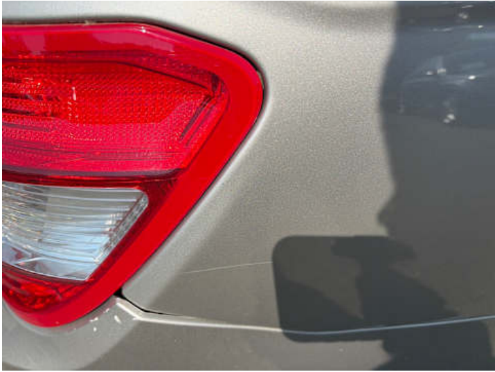
Seitenteil hinten rechts (Kratzer)
