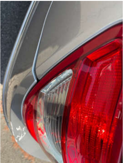
Stoßstange hinten (Spaltmaße ungenau)
