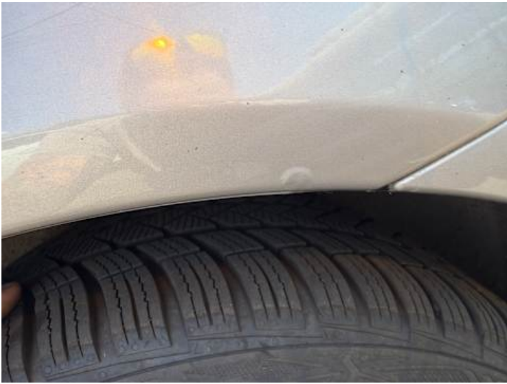
Seitenteil hinten links (Rost)
