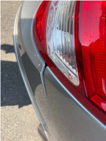
Stoßstange hinten (Spaltmaße ungenau)
