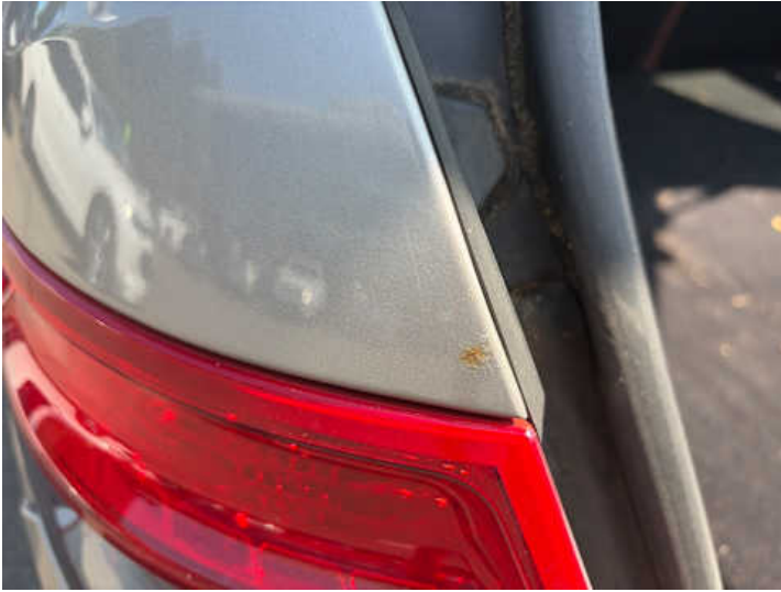
Seitenteil hinten links (Rost)
