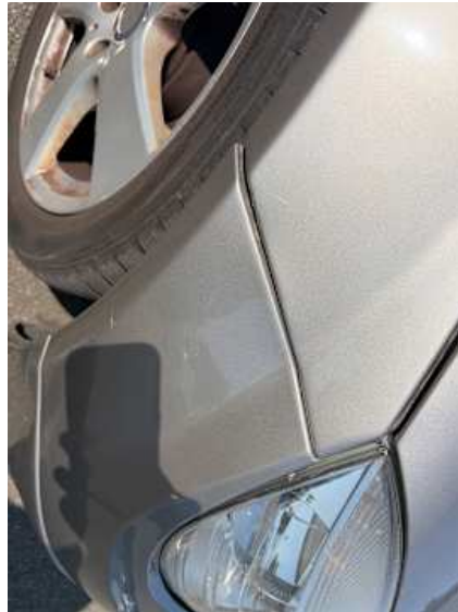
Stoßstange vorne (Spaltmaße ungenau)
