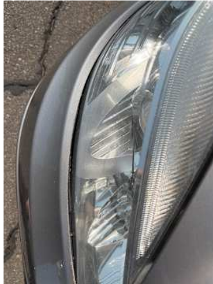
Stoßstange vorne (Spaltmaße ungenau)
