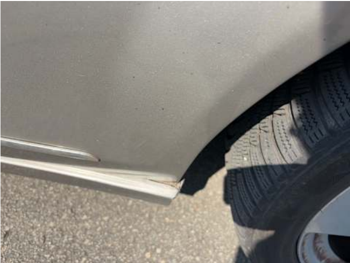
Schweller rechts (Spaltmaße ungenau)
