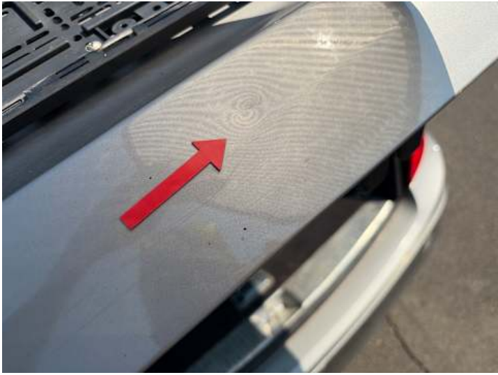
Heckklappe (Delle, Lackschaden)
