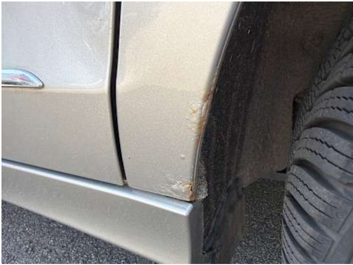
Seitenteil hinten links (Rost)
