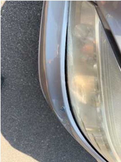
Stoßstange vorne (Spaltmaße ungenau)
