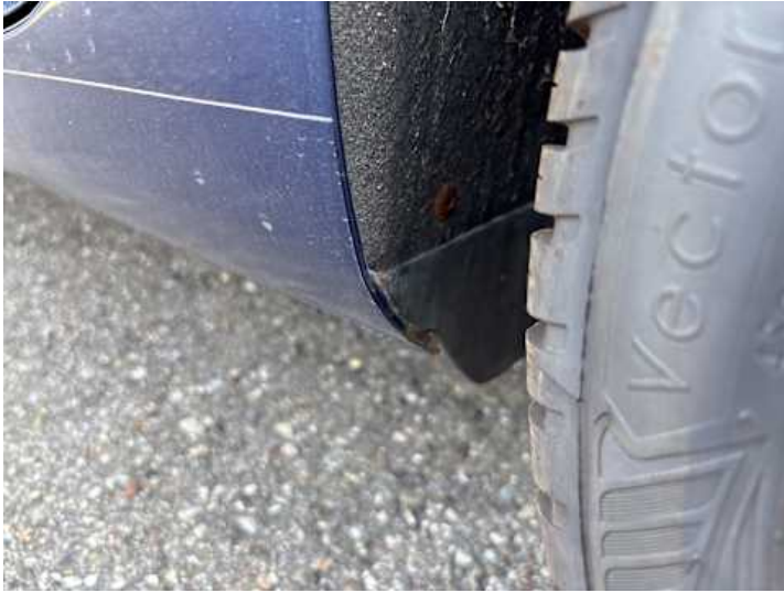
Schweller links (Rost)
