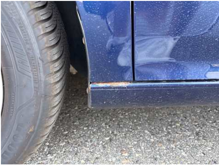
Schweller links (Rost)
