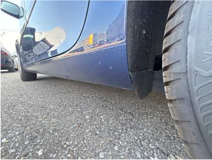
Schweller links (Rost)
