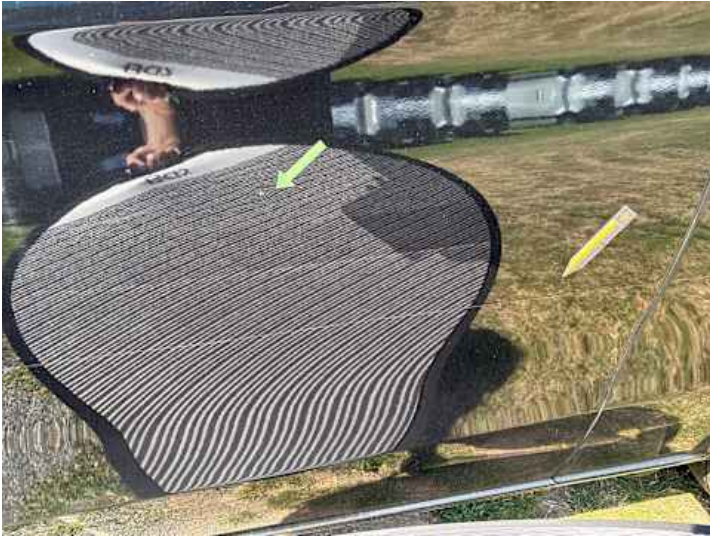
Türe hinten links (Kratzer, Delle)
