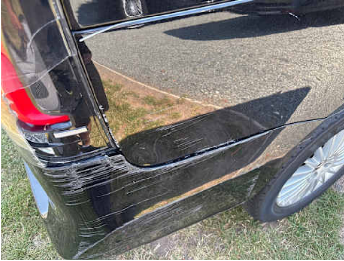
Stoßstange hinten (Kratzer, Spaltmaße ungenau, Lackschaden)
