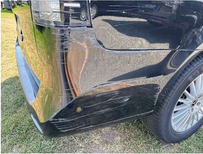
Stoßstange hinten (Kratzer, Spaltmaße ungenau, Lackschaden)
