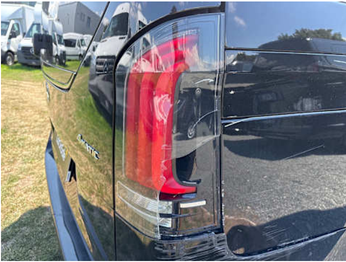
Rücklicht (rechts) (Riss/Bruch)
