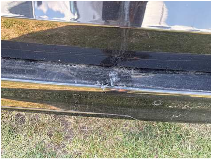
Stoßstange hinten (Kratzer, Spaltmaße ungenau, Lackschaden)
