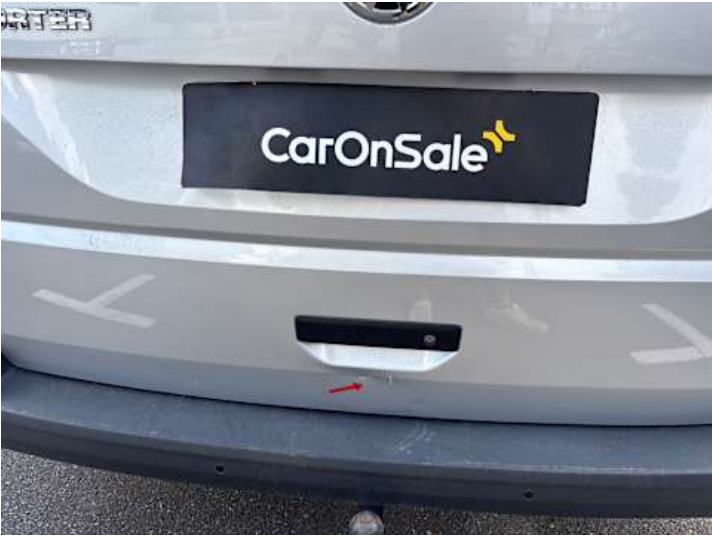
Heckklappe (Delle, Verformung)
