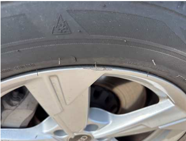
Rad (Kerben, Kratzer, Riss/Bruch)
