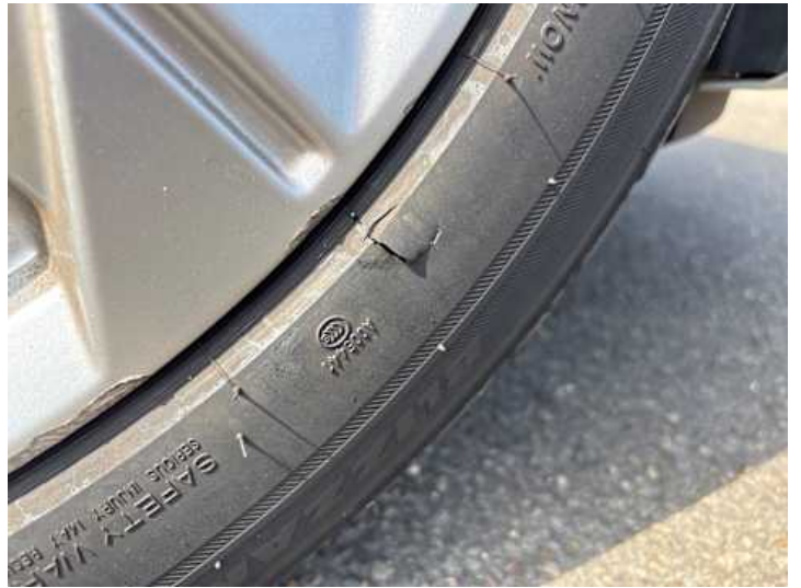
Rad (Kerben, Kratzer, Riss/Bruch)
