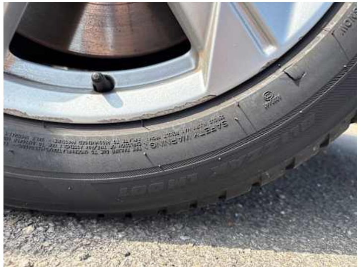
Rad (Kerben, Kratzer, Riss/Bruch)
