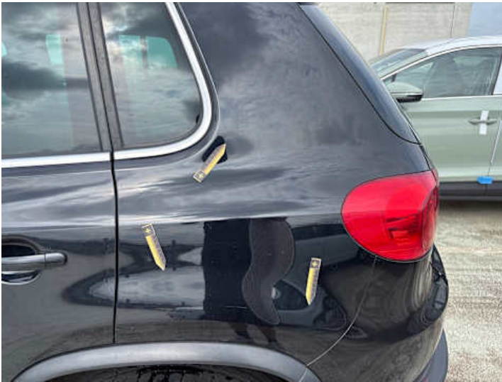
Seitenteil hinten links (Ausgeblichen/Matt, Kratzer, Lackschaden)
