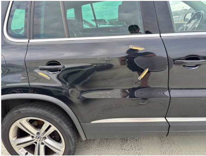
Türe hinten rechts (Delle, Kratzer)
