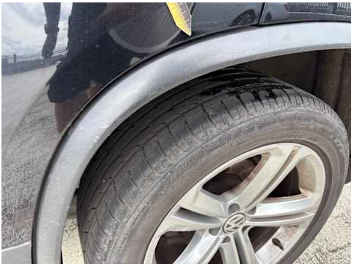
Seitenteil hinten links (Ausgeblichen/Matt, Kratzer, Lackschaden)
