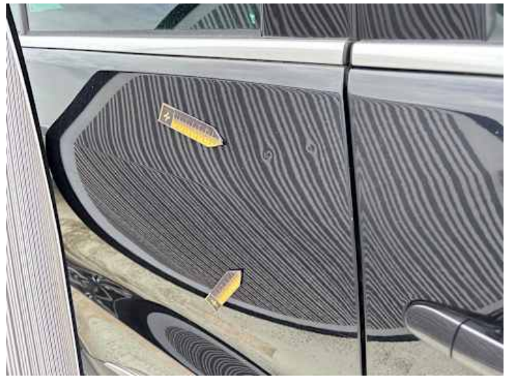
Türe hinten rechts (Delle)
