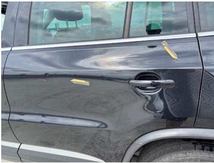
Türe hinten links (Lackschaden, Kratzer)
