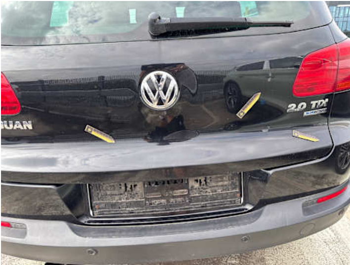
Heckklappe (Lackschaden, Kratzer)
