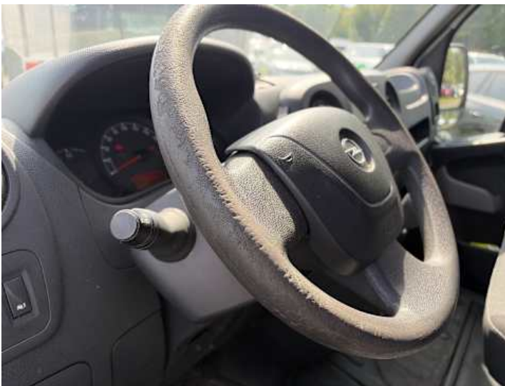
Innenraum (Verschleiß, Kratzer, Riss/Bruch)
