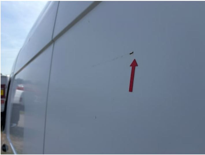
Seitenteil hinten links (Lackschaden, Rost)
