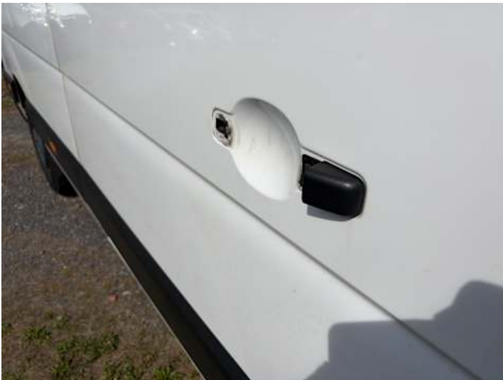
Türe hinten rechts (Riss/Bruch)
