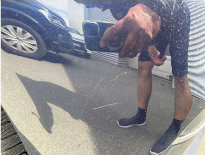
Stoßstange vorne (Kratzer, Lackschaden)
