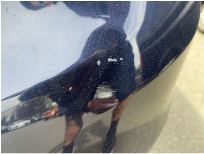
Stoßstange hinten (Kratzer, Lackschaden)
