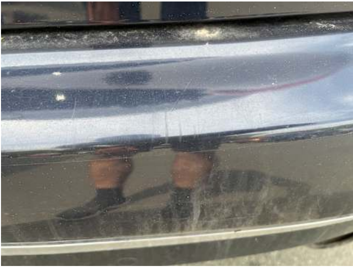
Stoßstange hinten (Kratzer, Lackschaden)
