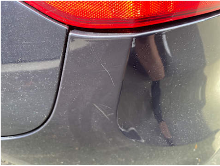
Stoßstange hinten (Kratzer, Lackschaden)
