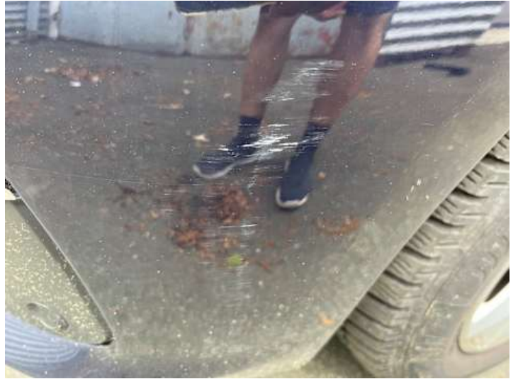
Stoßstange vorne (Kratzer, Lackschaden)
