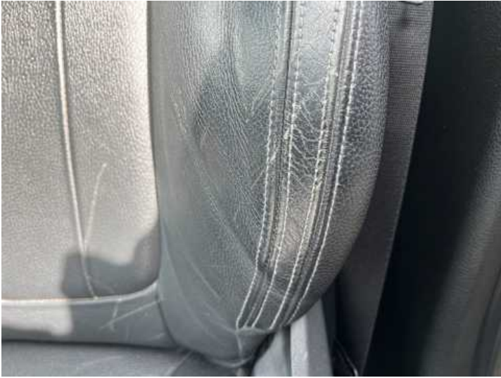
Innenraum (Riss/Bruch, Verschmutzung)
