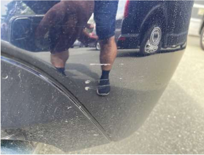
Stoßstange hinten (Kratzer, Lackschaden)
