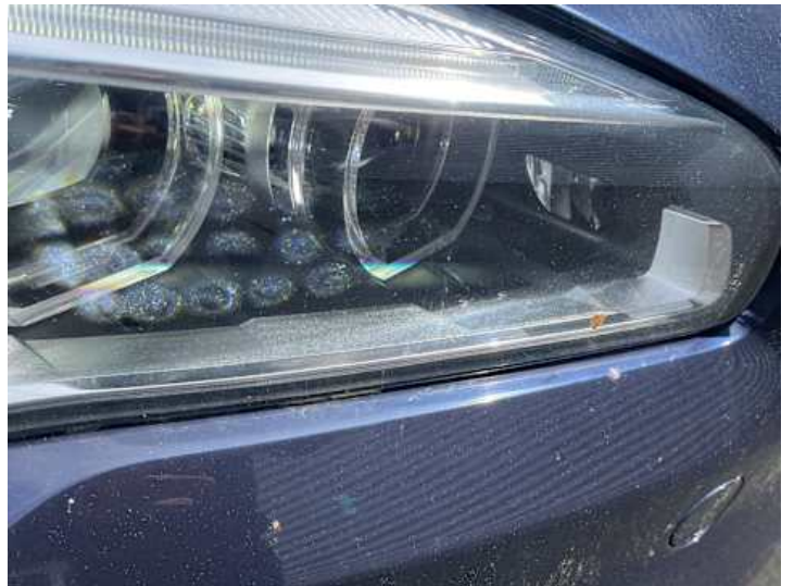
Scheinwerfer (rechts) (Steinschlag)
