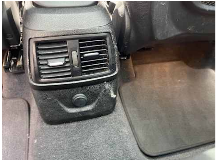
Innenraum (Riss/Bruch, Verschmutzung)
