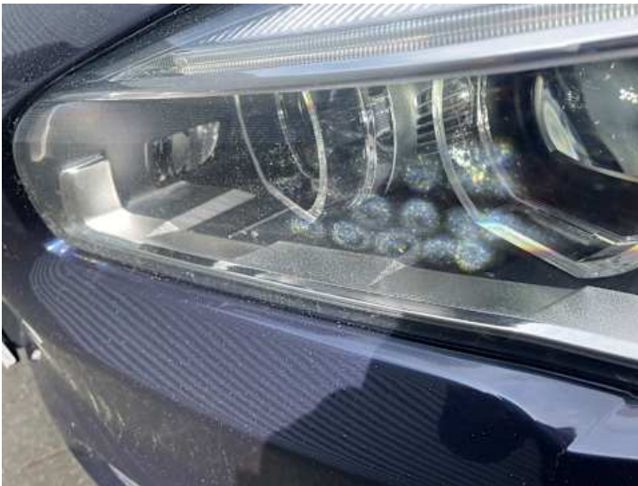
Scheinwerfer (links) (Steinschlag)
