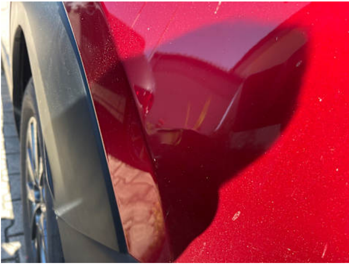
Stoßstange hinten (Lackschaden, Kratzer, Verformung)
