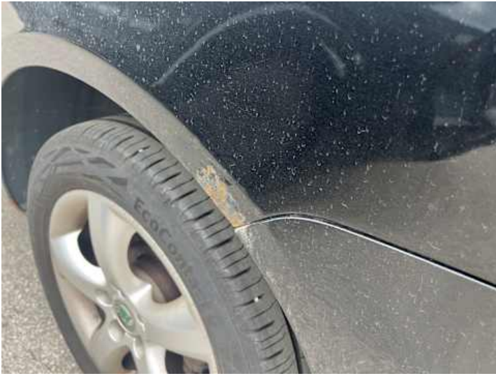
Seitenteil hinten links (Rost, Lackschaden)
