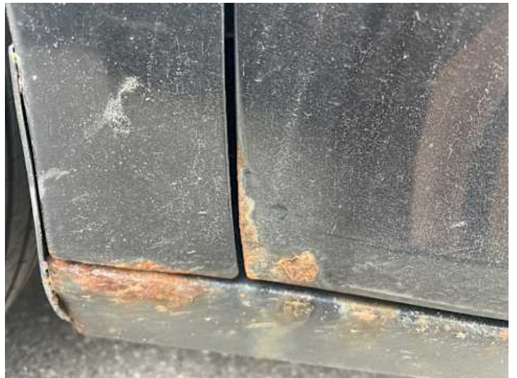
Kotflügel vorne links (Rost)
