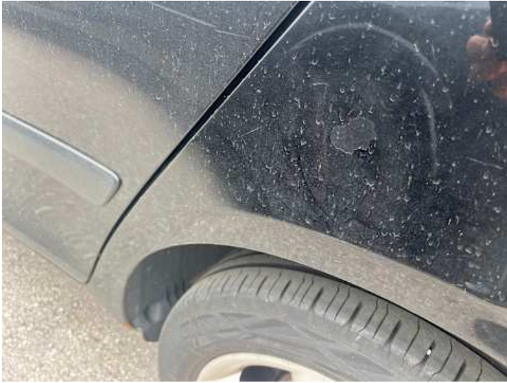
Seitenteil hinten links (Rost, Lackschaden)
