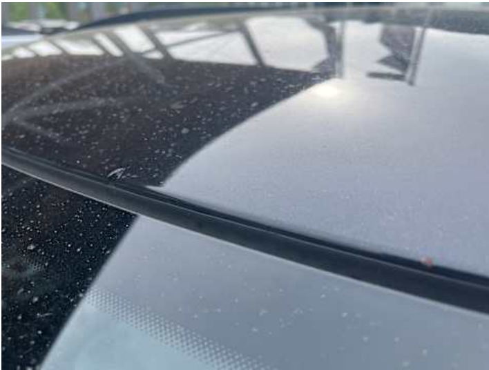
Dach (Rost, Lackschaden, Delle)
