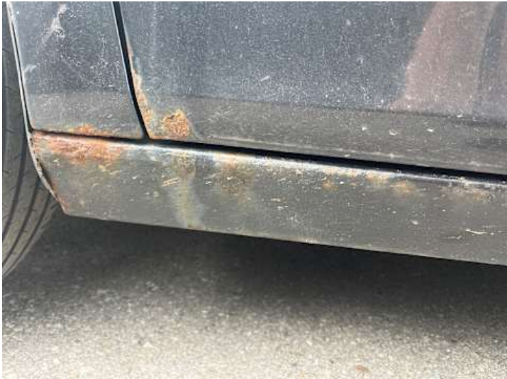
Schweller links (Rost, Lackschaden)
