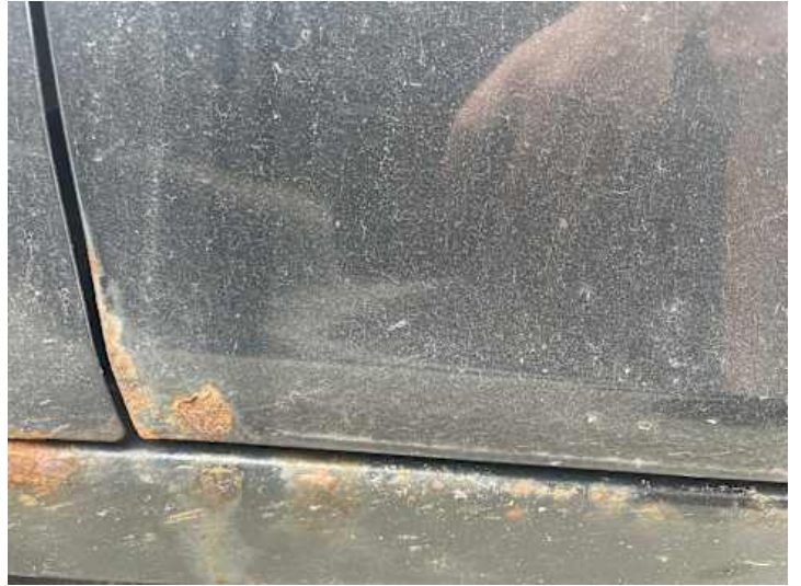
Fahrertür (Lackschaden, Rost)
