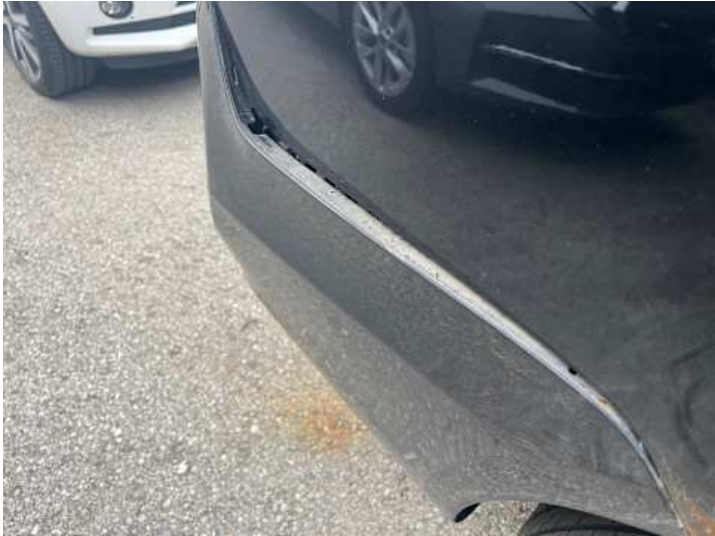
Stoßstange hinten (Riss/Bruch, Verformung, Spaltmaße ungenau)
