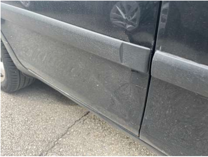
Türe hinten rechts (Verformung, Lackschaden)
