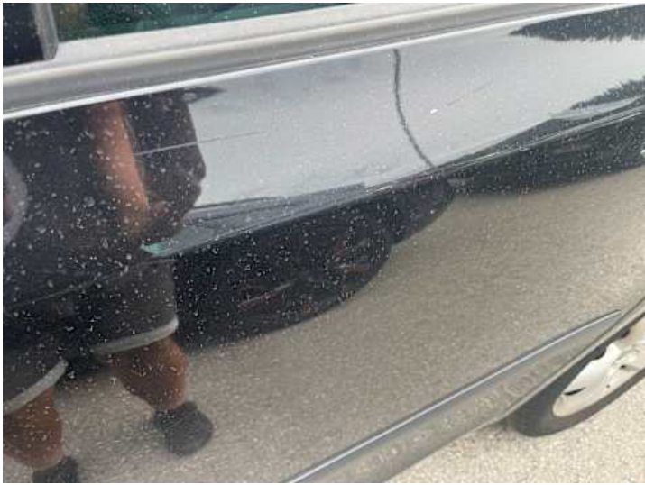
Türe hinten links (Rost, Lackschaden)
