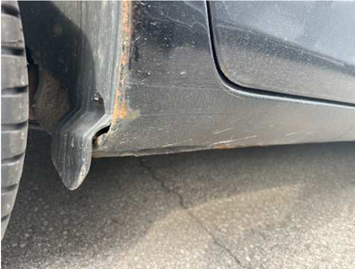
Schweller rechts (Rost, Lackschaden)
