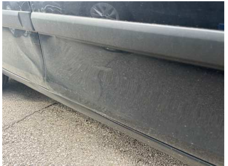
Beifahrertür (Rost, Lackschaden, Verformung)
