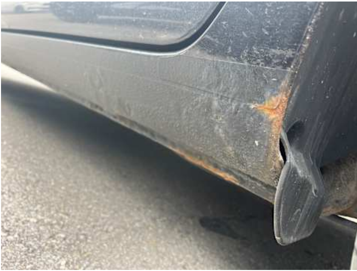
Schweller links (Rost, Lackschaden)
