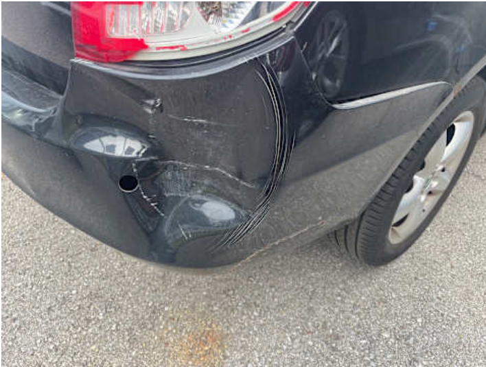
Stoßstange hinten (Riss/Bruch, Verformung, Spaltmaße ungenau)
