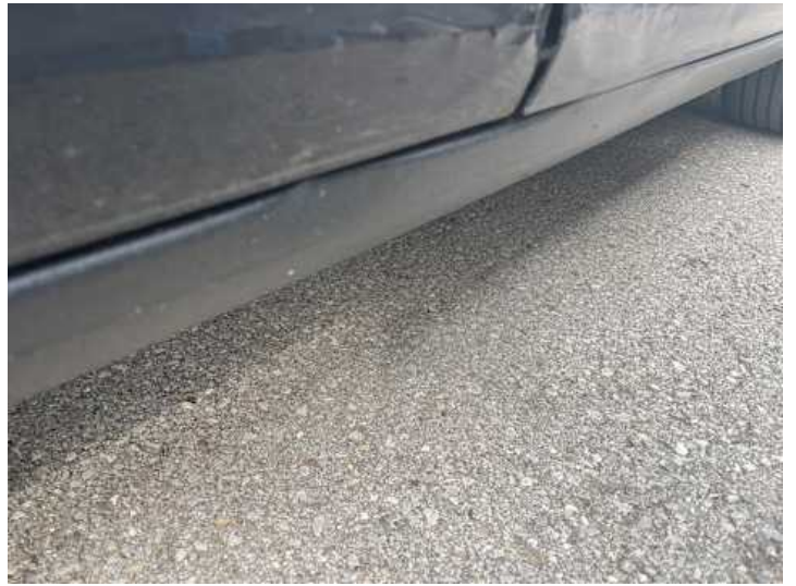
Schweller rechts (Verformung)
