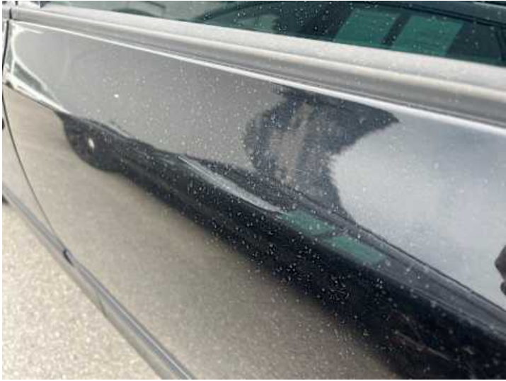
Türe hinten links (Lackschaden)
