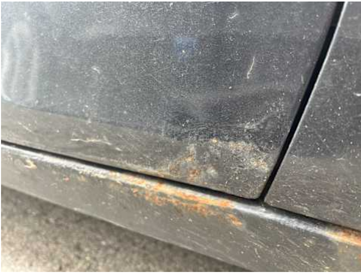
Beifahrertür (Rost, Lackschaden, Verformung)
