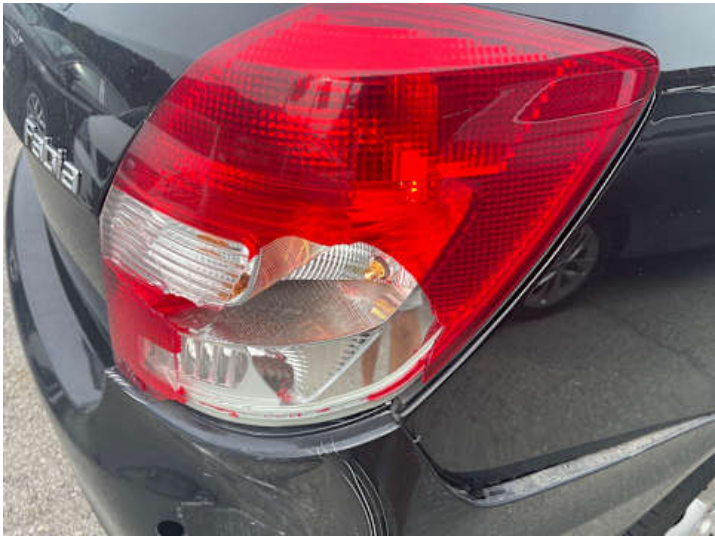
Rücklicht (rechts) (Riss/Bruch)
