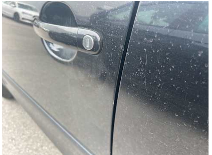
Fahrertür (Lackschaden, Rost)
