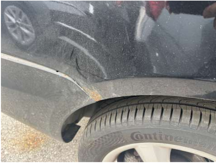
Seitenteil hinten rechts (Rost, Lackschaden)
