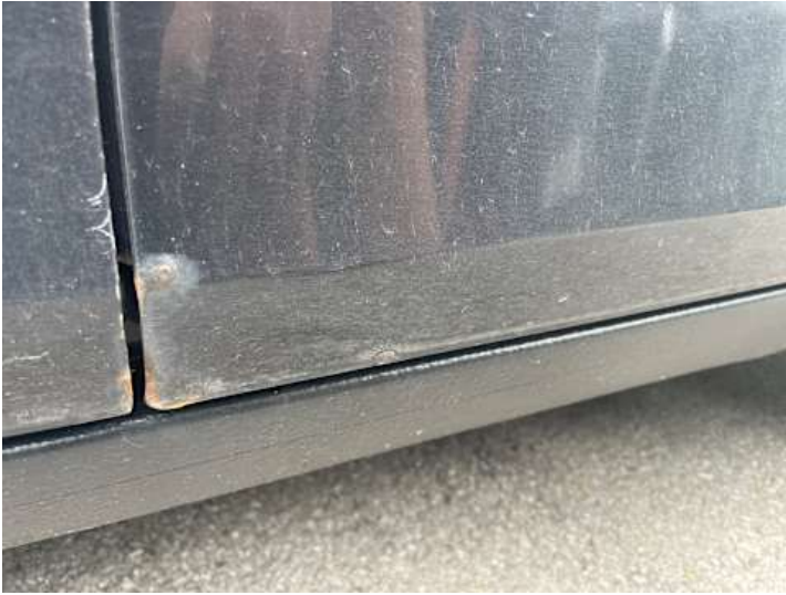
Türe hinten links (Rost, Lackschaden)
