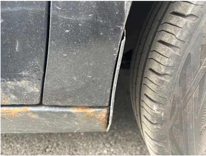
Kotflügel vorne rechts (Rost)
