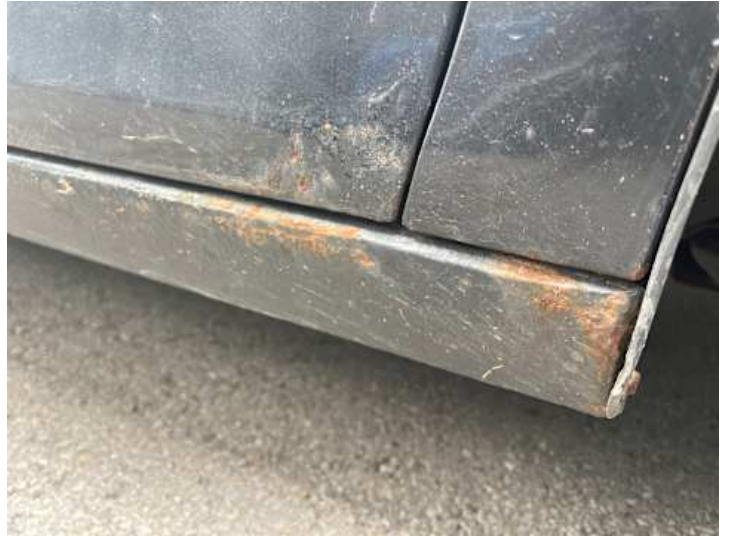
Schweller rechts (Rost, Lackschaden)
