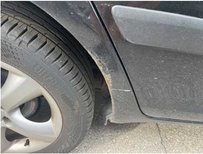
Seitenteil hinten rechts (Rost, Lackschaden)
