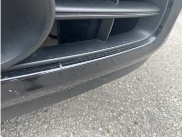
Stoßstange vorne (Lackschaden)
