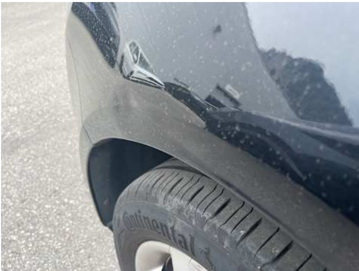
Kotflügel vorne links (Lackschaden, Verformung)
