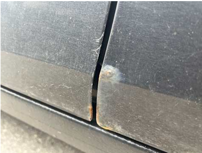
Fahrertür (Lackschaden, Rost)
