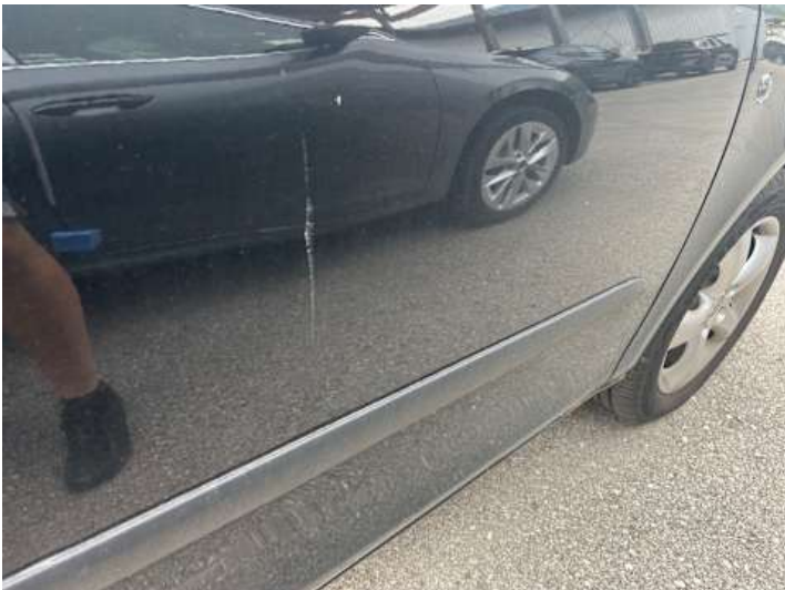
Beifahrertür (Rost, Lackschaden, Verformung)
