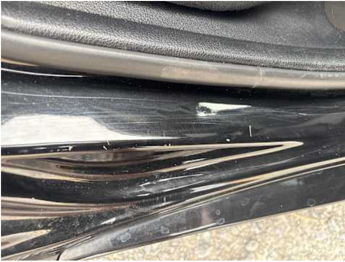
Schweller rechts (Delle, Kratzer)
