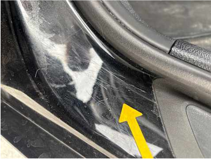
Schweller links (Kratzer)
