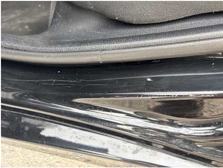
Schweller links (Kratzer)
